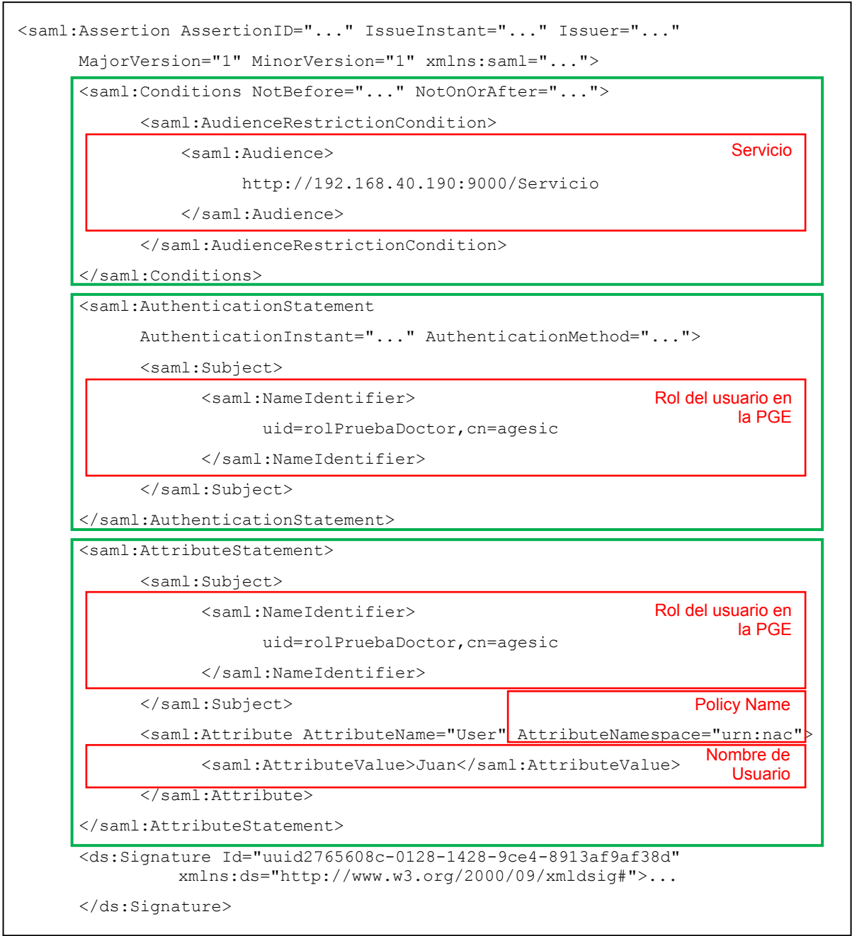
Figura 3 – Ejemplo de un token SAML emitido por el STS de la PGE
