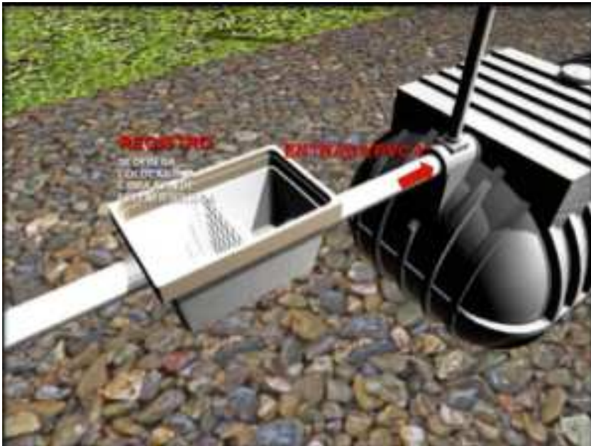
Registro antes del Bio Digestor
