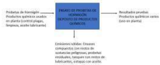
DIAGRAMA DE FLUJO DEL SECTOR 4: LABORATORIO DE ENSAYOS FÍSICOS Y ALMACENAMIENTO DE PRODUCTOS QUÍMICOS
