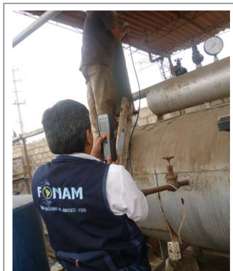
Medición de gases de combustión a la caldera
