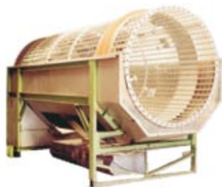
Fulón metálico utilizado en sacudido de sal
