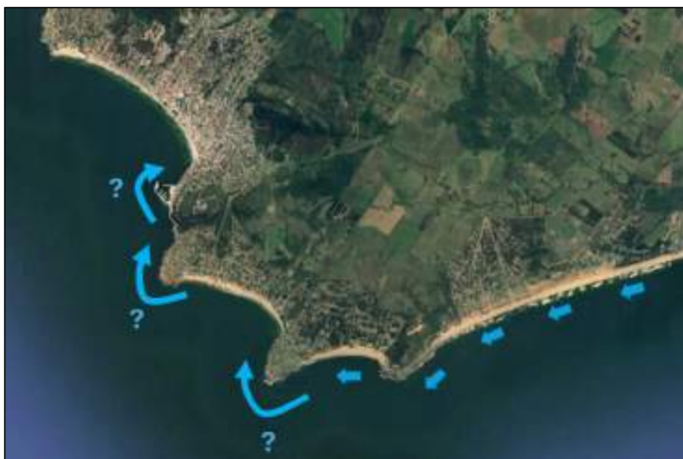
Figura 39 – Potencial bypass de arena desde el arco Portezuelo-Punta Negra hacia la playa de Piriápolis, a través de Punta Colorada, Punta Fría y el puerto de Piriápolis.
