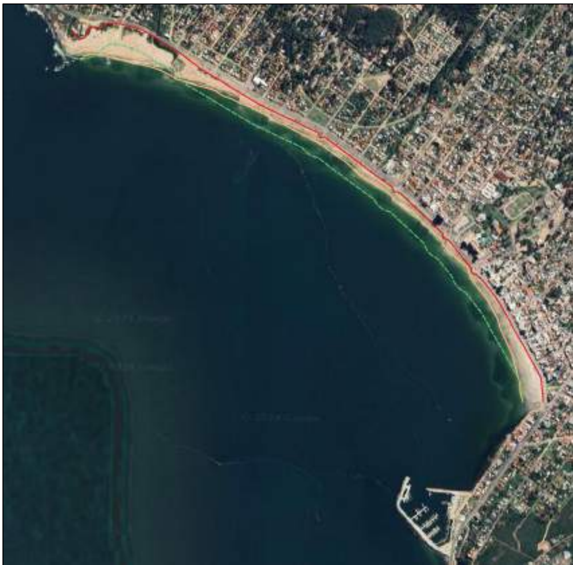
Figura 58 – Limite de la rambla (línea roja), línea de costa actual (línea naranja) y línea paralela a la rambla, a 110 m de distancia (línea verde punteada).
