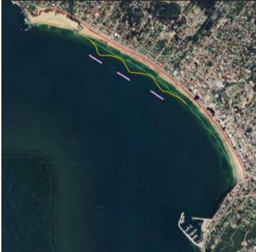
Figura 61 – Esquema conceptual de la Alternativa B.iii: relleno y estabilización con diques exentos o arrecifes artificiales.
