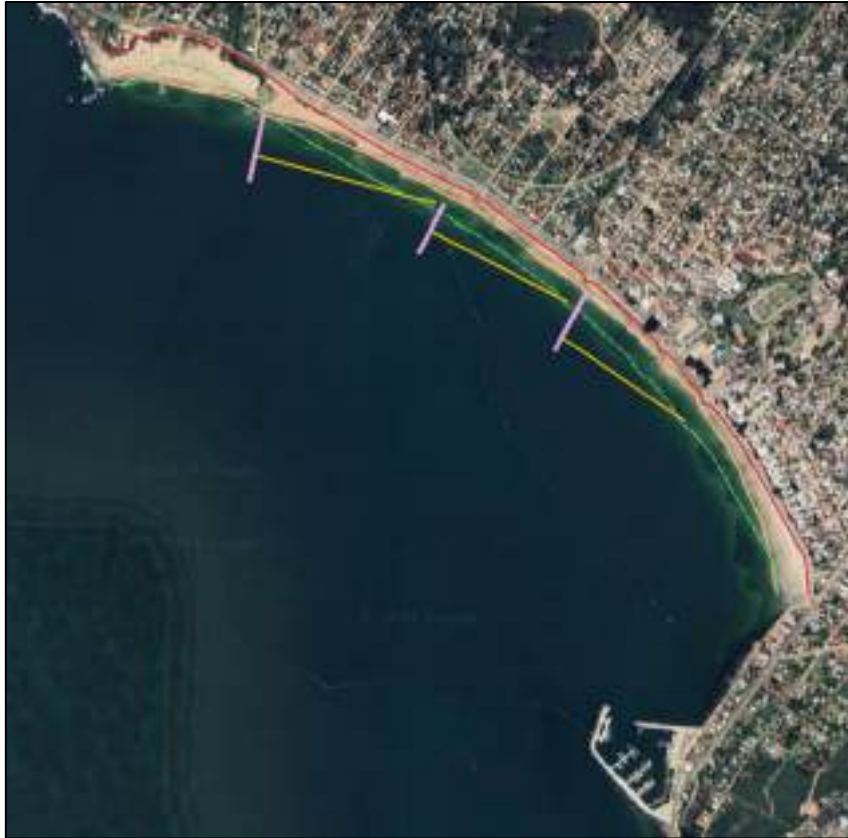
Figura 60 – Esquema conceptual de la Alternativa B.ii: relleno y estabilización con espigones “largos” o “de cierre”.
