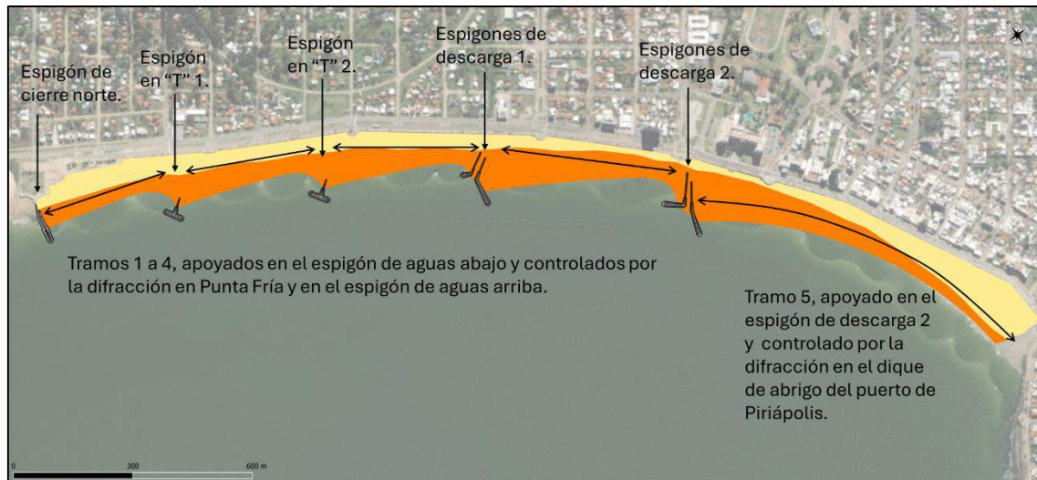
Figura 78 – Esquema de cómo está determinada la forma en planta en equilibrio en los distintos tramos de playa para la Alternativa 2. En amarillo la playa actual; en naranja el área a ganar con el relleno de playa; en gris las obras litorales a construir.
