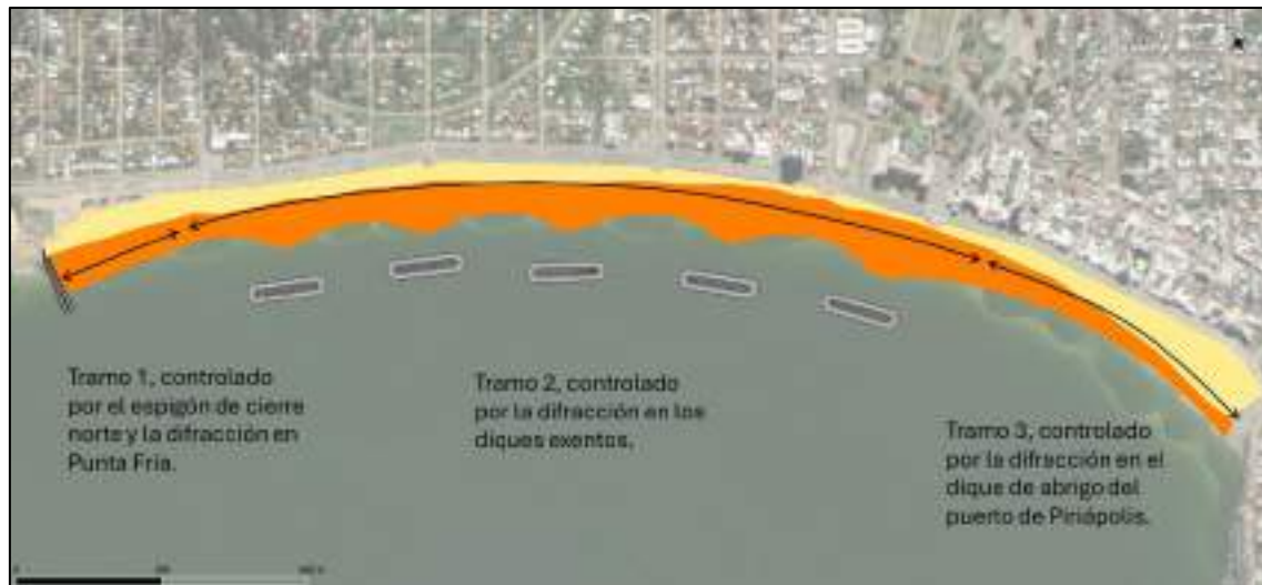
Figura 74 – Esquema de cómo está determinada la forma en planta en equilibrio en los distintos tramos de playa para la Alternativa 1. En amarillo la playa actual; en naranja el área a ganar con el relleno de playa; en gris las obras litorales a construir.
