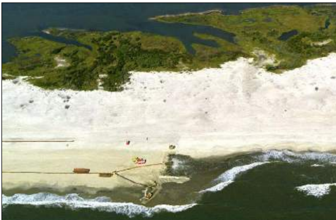
Figura 71 – Ejemplo de proceso constructivo de relleno de playas (tomado de https://www.nps.gov/articles/beach-nourishment.htm ).
