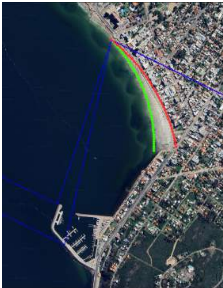
Figura 45 – Parábolas de equilibrio del tramo sur, construidas considerando el puerto actual (línea verde) y el puerto previo a la ampliación de 1997 (línea roja). Se considera la playa apoyada en el espigón de calle Armenia.
