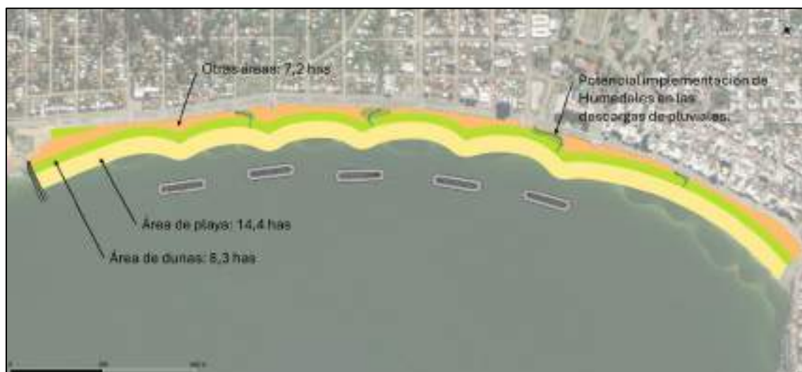
Figura 75 – Esquema de las áreas de playa, dunas y otros usos que se obtienen con la Alternativa 1.
