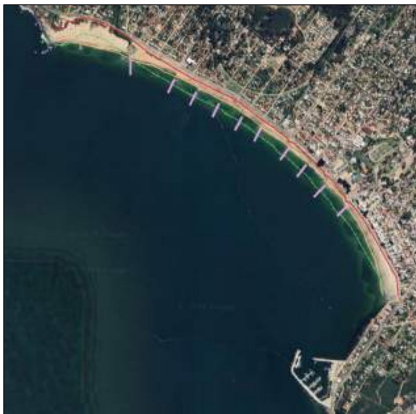
Figura 59 – Esquema conceptual de la Alternativa B.i: relleno y estabilización con campo de espigones “cortos”.
