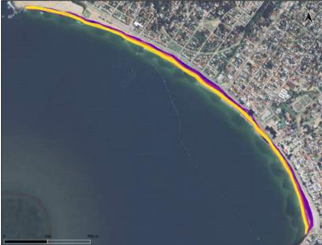
Figura 28 – Líneas de costa medianas anuales para el período 1985-2022 (los colores oscuros corresponden al inicio del período y los claros al final).
