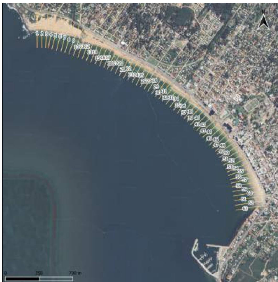
Figura 27 – Localización de los perfiles utilizados para el análisis de la evolución de la línea de costa a partir de imágenes satelitales.
