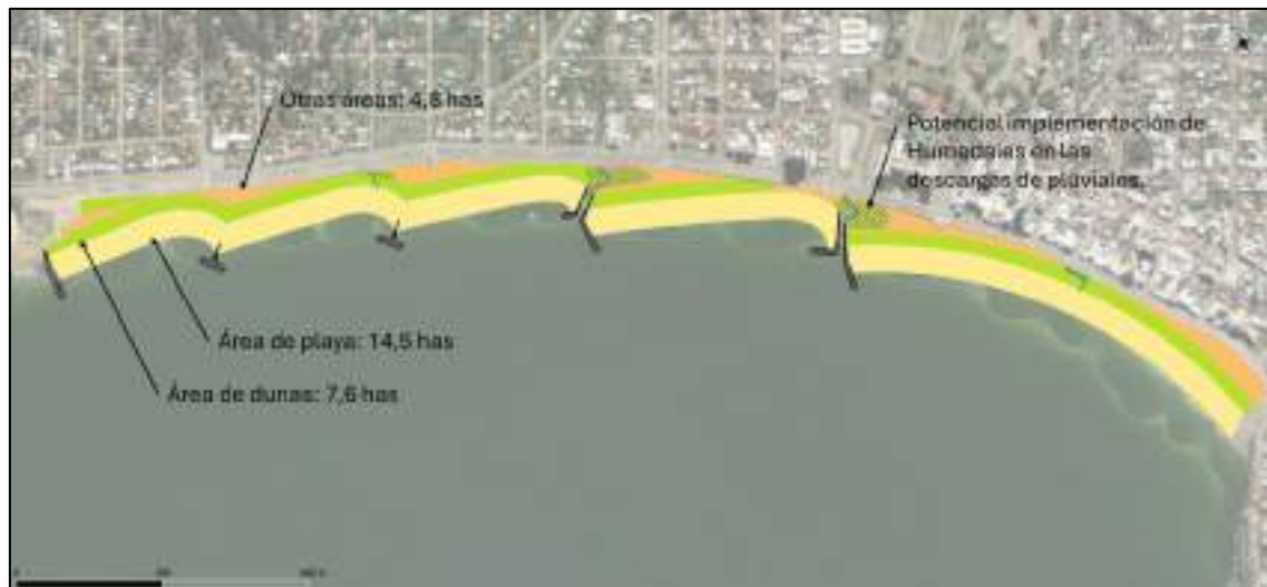
Figura 79 – Esquema de las áreas de playa, dunas y otros usos que se obtienen con la Alternativa 2.
