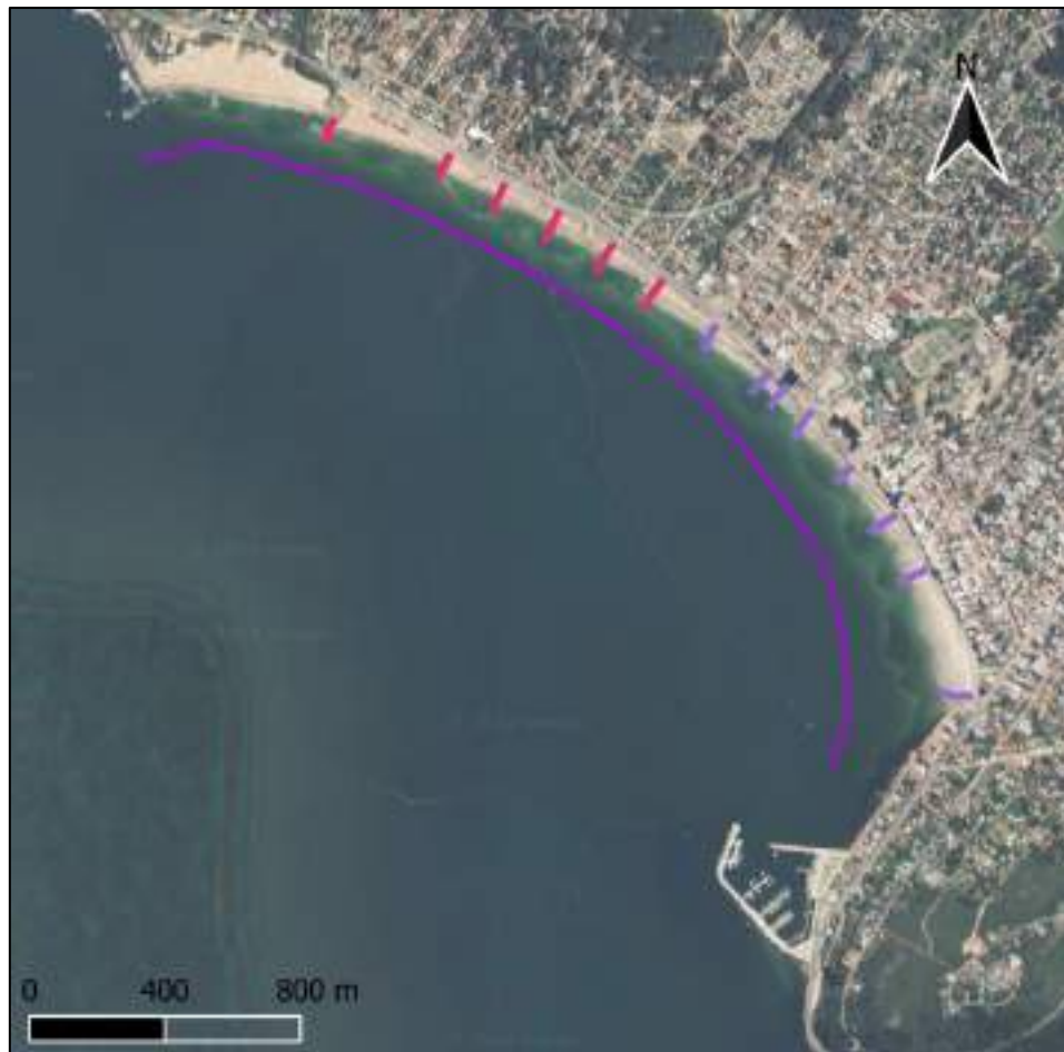
Figura 35 – Localización en planta del lugar común de las profundidades de cierre obtenidas para los distintos perfiles, junto con la ubicación de los espigones.
