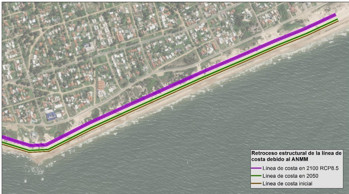
Figura 25. Retroceso estructural de la línea de costa debido al ANMM en 2050 y 2100 ampliado en Playa Pinares. La línea marrón representa la línea de costa inicial, la línea verde (2050, RCP promedio) y moradas (2100, RCP8.5) representan la línea de costa en el futuro debido al ANMM.
