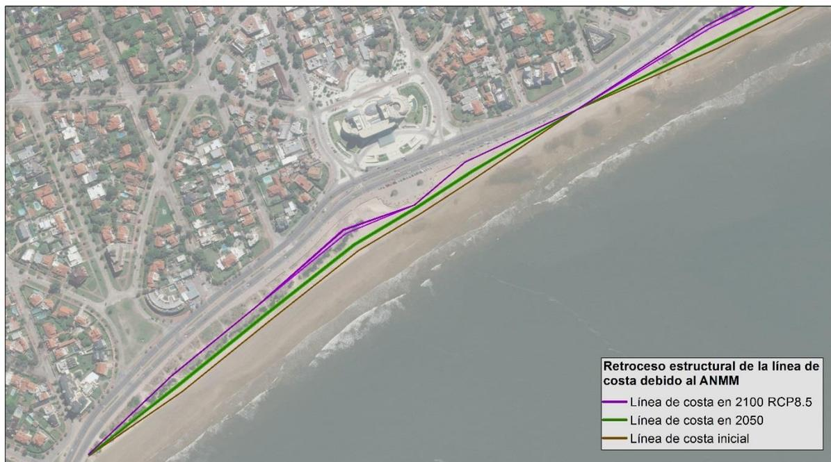
Figura 28. Retroceso estructural de la línea de costa debido al ANMM en 2050 y 2100 ampliado en Playa Carrasco. La línea marrón representa la línea de costa inicial, la línea verde (2050, RCP promedio) y moradas (2100, RCP8.5) representan la línea de costa en el futuro debido al ANMM.
