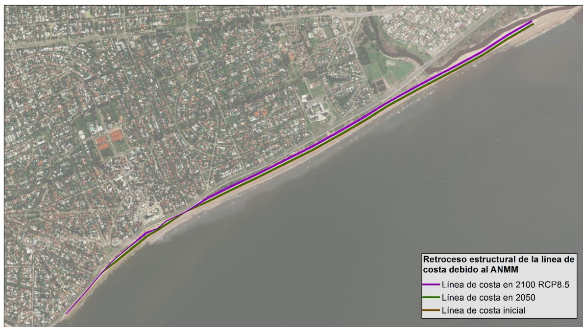
Figura 35. Retroceso estructural de la línea de costa debido al ANMM en 2050 y 2100 en Playa Carrasco. La línea marrón representa la línea de costa inicial, la línea verde (2050, RCP promedio) y moradas (2100, RCP8.5) representan la línea de costa en el futuro debido al ANMM.
