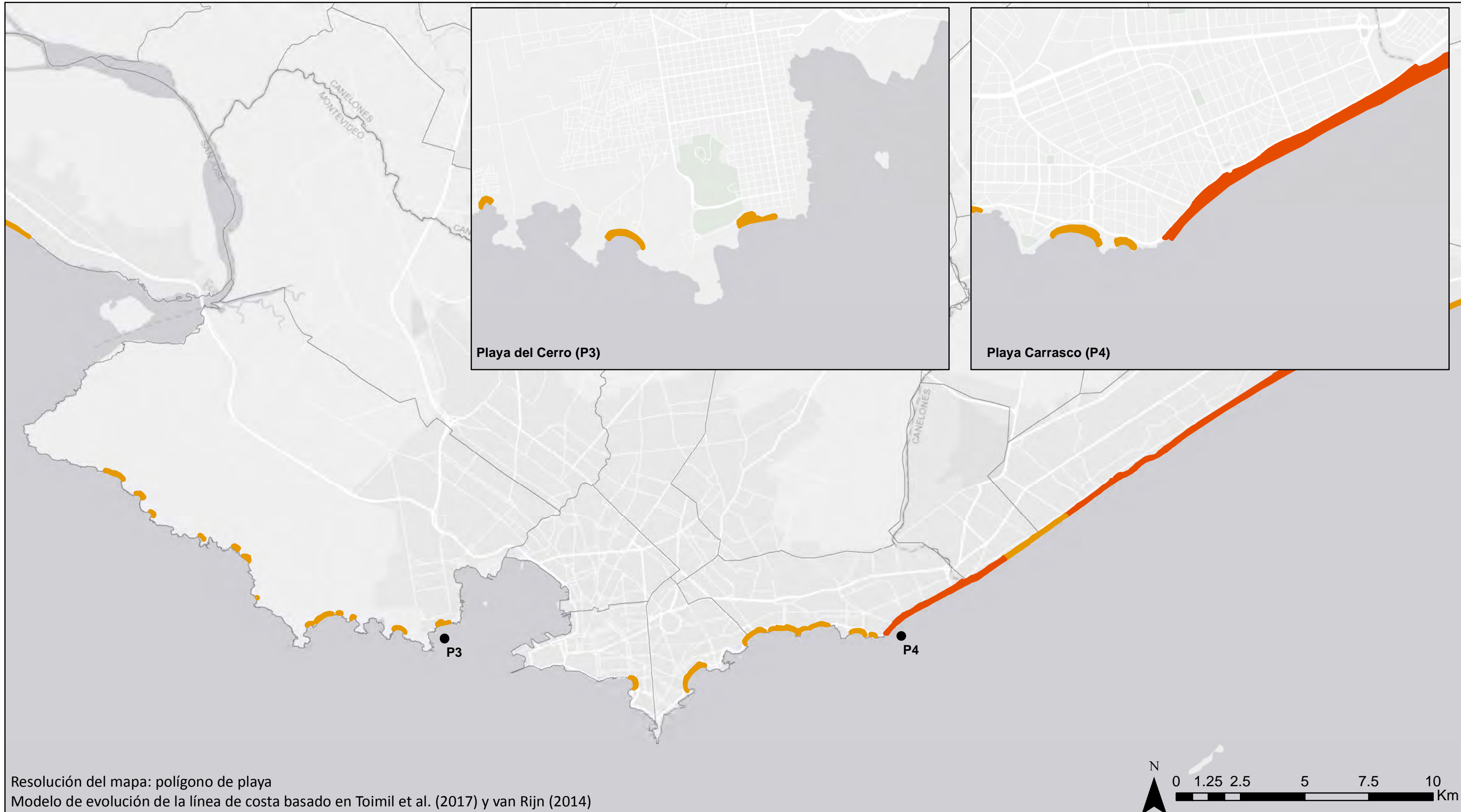
Mapa de retroceso estructural de la línea de costa, expresado en metros, para el horizonte 2100, escenario RCP8.5, valor medio de ANMM
