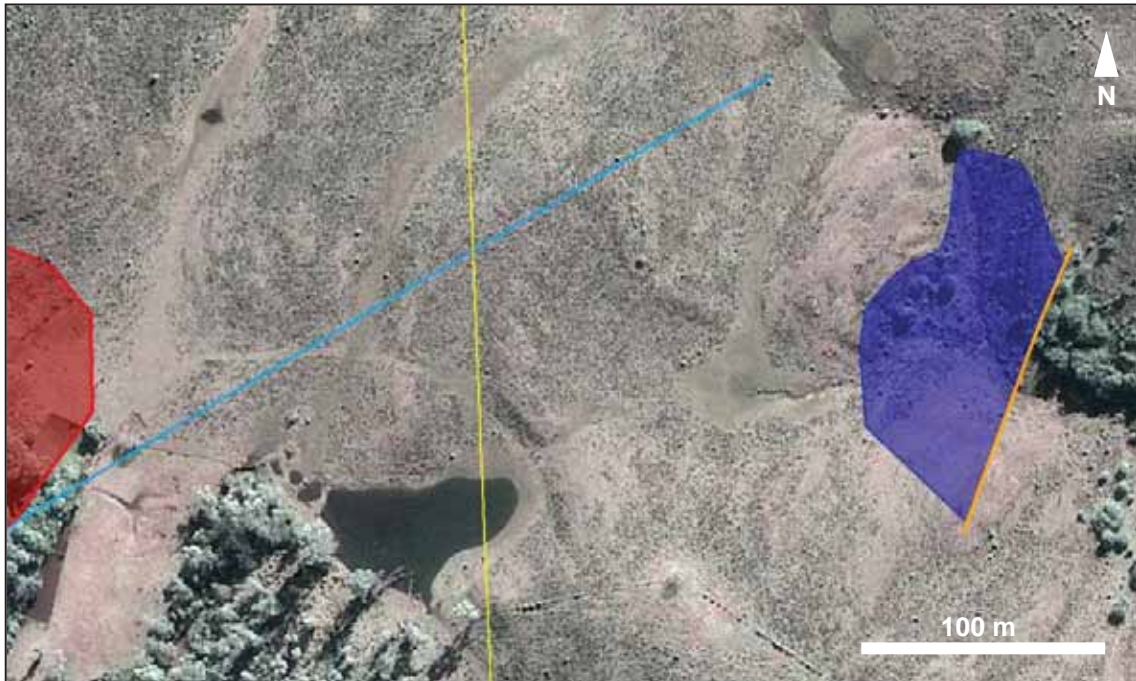
Figura 9-6: Unidad de sedimentación 1. La línea anaranjada indica la ubicación del dique y el polígono azul el área del espejo de agua al nivel de la corona del dique.
