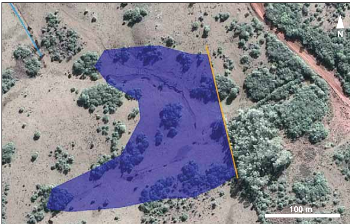
Figura 9-7: Unidad de sedimentación 2. La línea anaranjada indica la ubicación del dique y el polígono azul el área del espejo de agua al nivel de la corona del dique.
