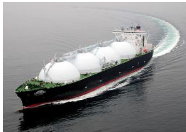
LNGC con tanques esféricos
