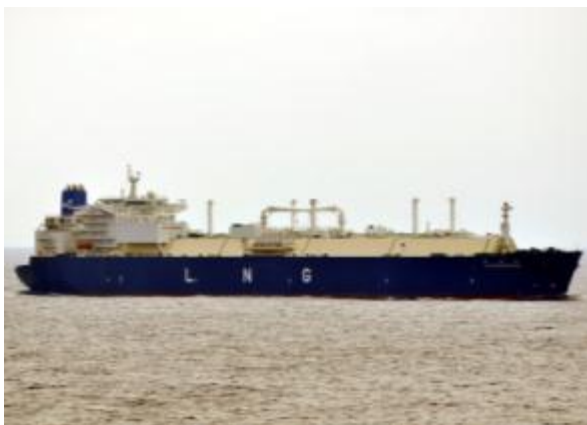
LNGC de tanques de membrana
