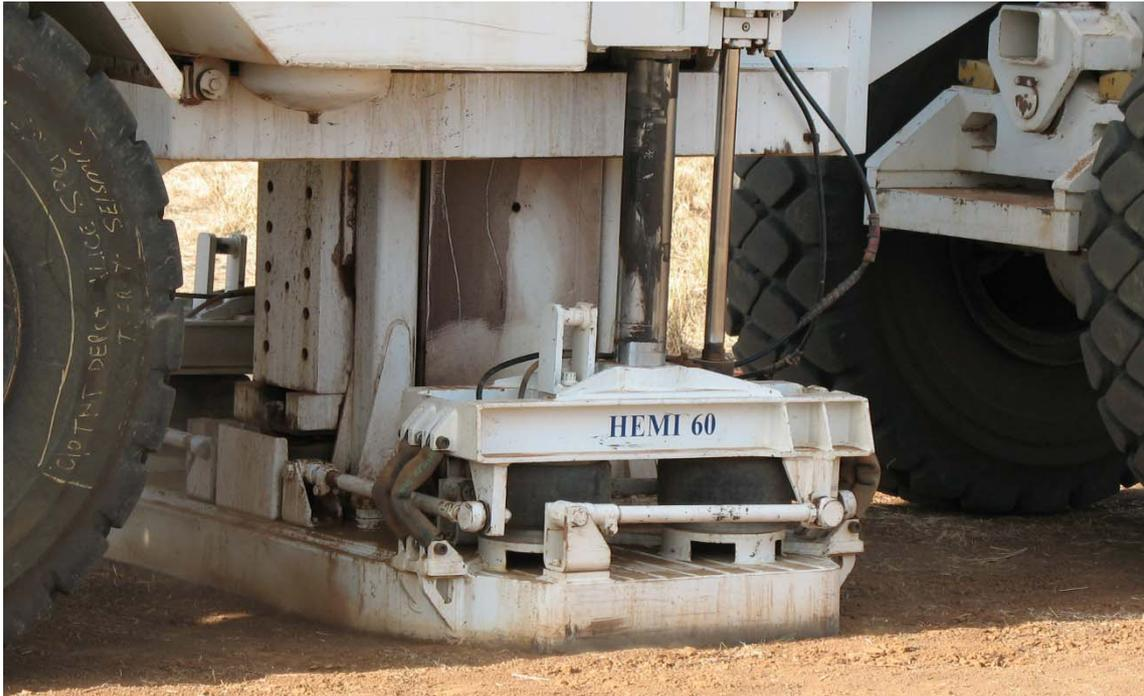
**Figura 4-2.- Camión generando vibración**
