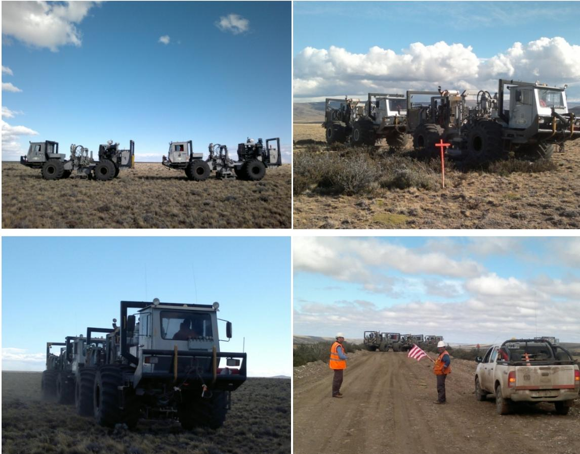
Figura 4-1.- Camiones *Vibroseis*
