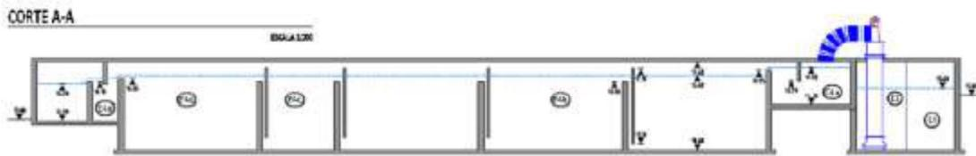
Figura 2-17: Contactor de Ozono, corte.
