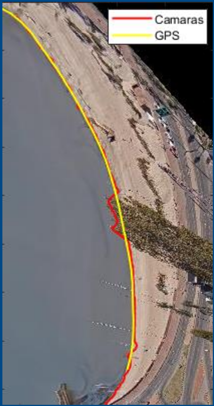
Verificación de la detección de la línea de costa Playa Ramírez
