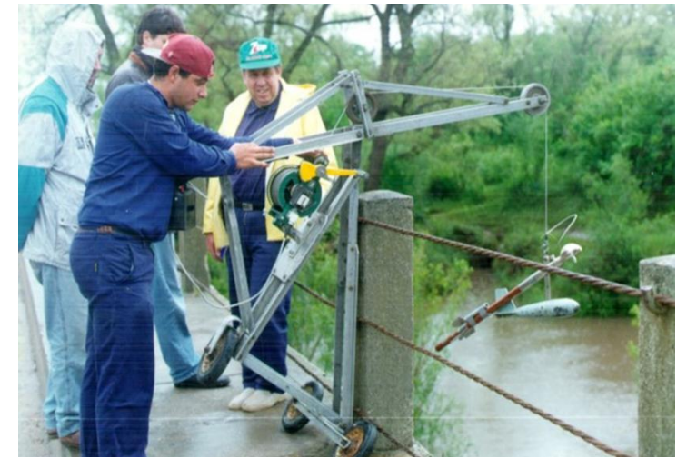
Los caudales se determinan mediante mediciones directas de caudal (aforos)
