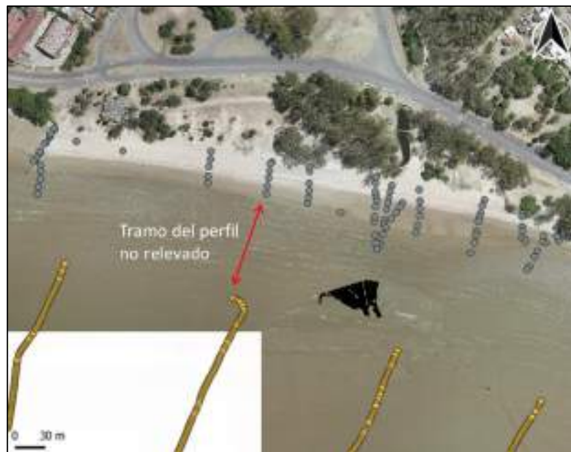
Figura 4-78 Ejemplo de levantamientos topobatimétricos en que hay entre 50 m y 100 m de perfil de playa sin relevar.
