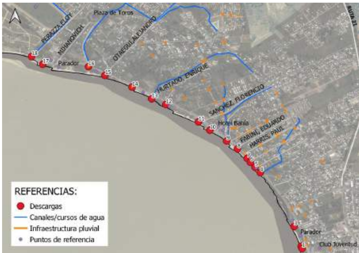
Figura 4-48 Descarga pluviales a la costa – Playa Colonia del Sacramento
