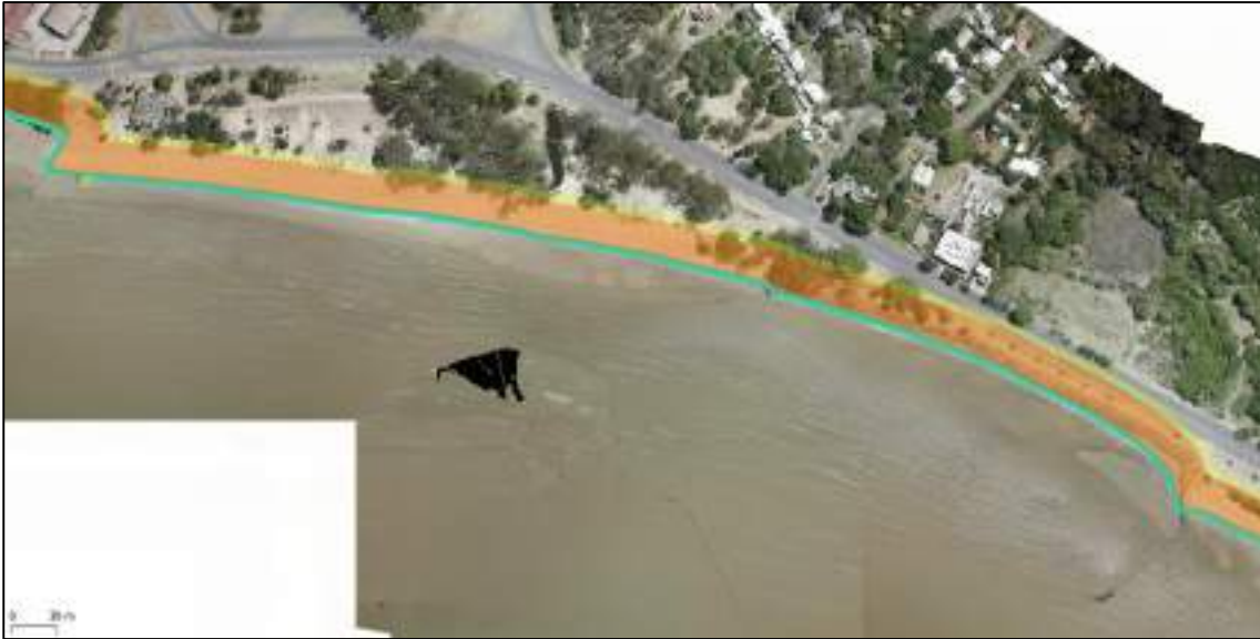
Figura 4-36 – Tramo de costa correspondiente a la playa del Real de San Carlos. Línea de costa actual según ortofoto proporcionada por la Intendencia de Colonia (celeste); franja de 25 m correspondiente a evento de erosión de 10 años de período de retorno (naranja); franja de 31 m correspondiente a evento de erosión de 10 años de período de retorno (amarillo).
