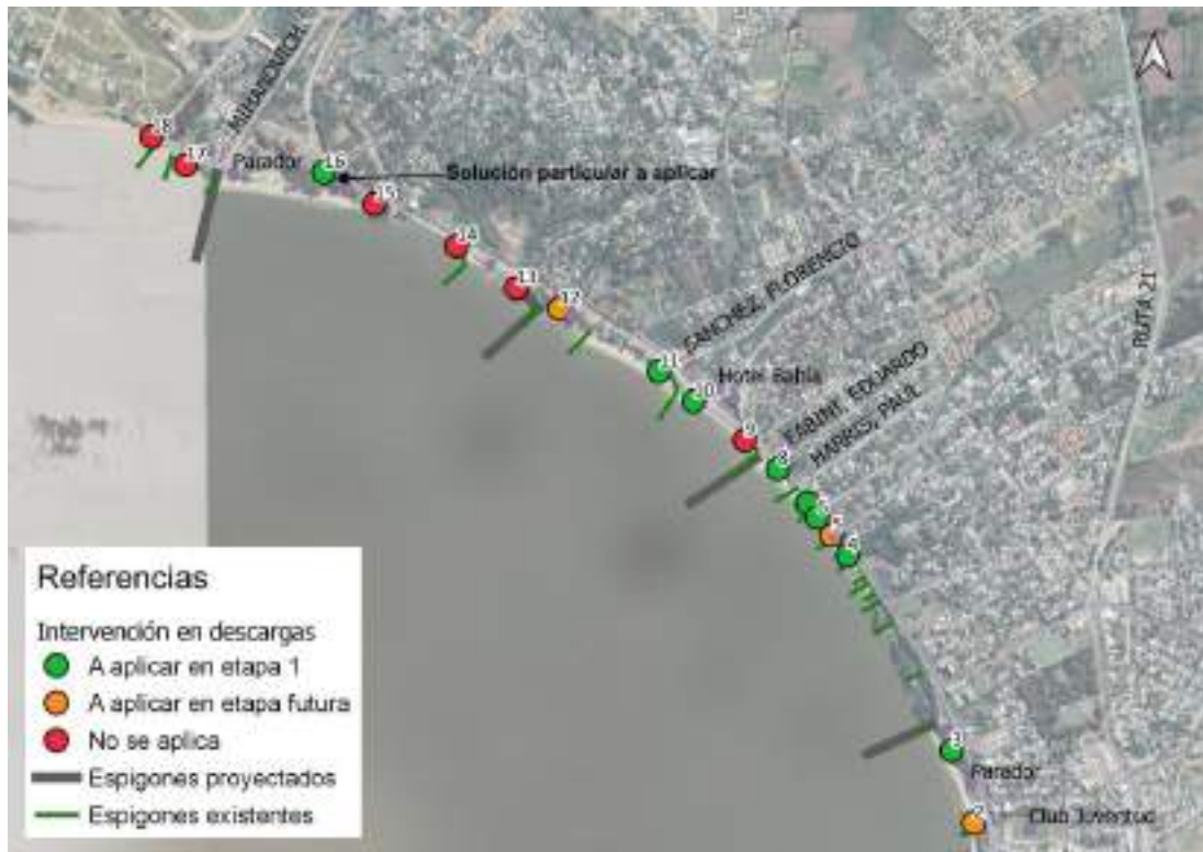
Figura 4-81: Categorización de las descargas según la aplicación de la intervención tipo.
