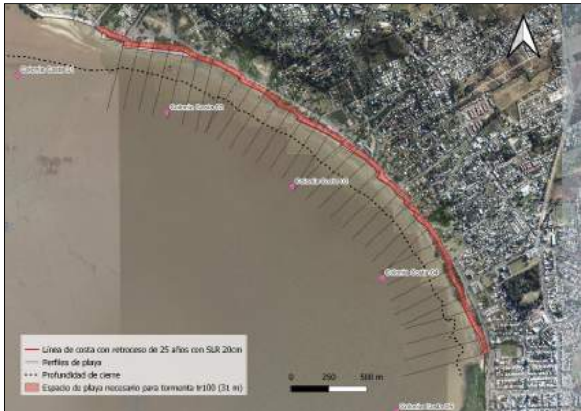
Figura 4-46 Línea de costa proyectada para 2050, considerando aumento del nivel medio del mar de 20 cm, y franja de variabilidad del perfil de playa considerando retroceso del perfil de 100 años de período de retorno
