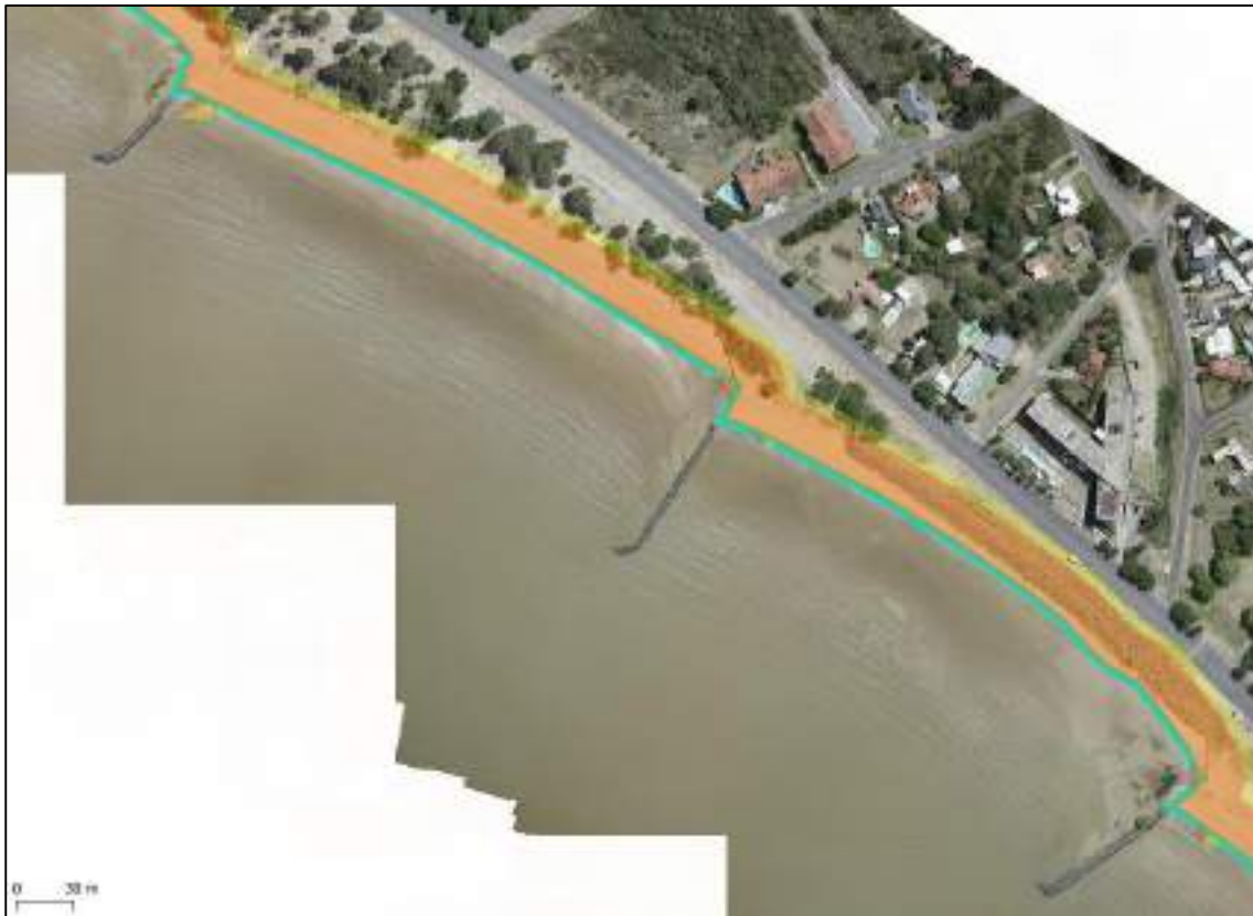
Figura 4-37 – Tramo de costa entre las calles Francisco Acuña de Figueroa y Arq. Julio Vilamajó. Línea de costa actual según ortofoto proporcionada por la Intendencia de Colonia (celeste); franja de 25 m correspondiente a evento de erosión de 10 años de período de retorno (naranja); franja de 31 m correspondiente a evento de erosión de 10 años de período de retorno (amarillo).
