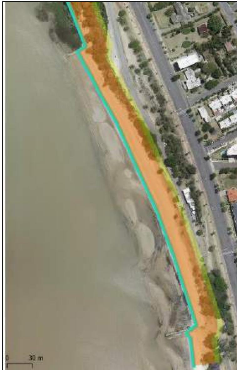
Figura 4-38 – Tramo de costa entre las calles González Moreno y Zorrilla de San Martín. Línea de costa actual según ortofoto proporcionada por la Intendencia de Colonia (celeste); franja de 25 m correspondiente a evento de erosión de 10 años de período de retorno (naranja); franja de 31 m correspondiente a evento de erosión de 10 años de período de retorno (amarillo).
