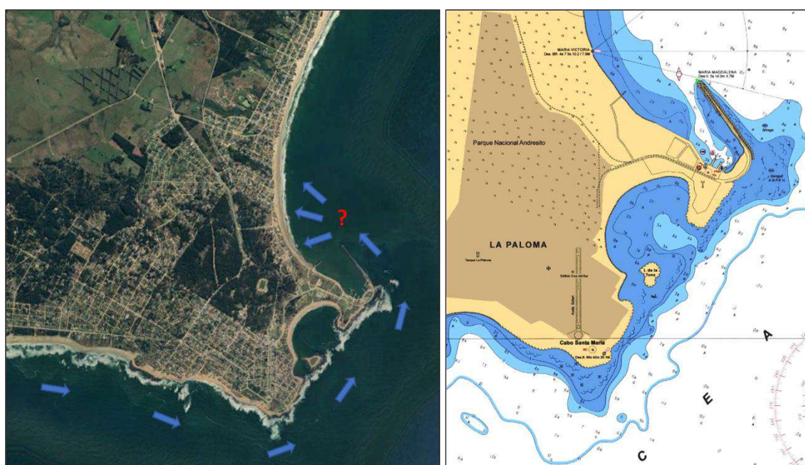
Figura 4-29 – Esquema de bypass de arena (izquierda) y detalle de la carta náutica ROU 19 (derecha).
