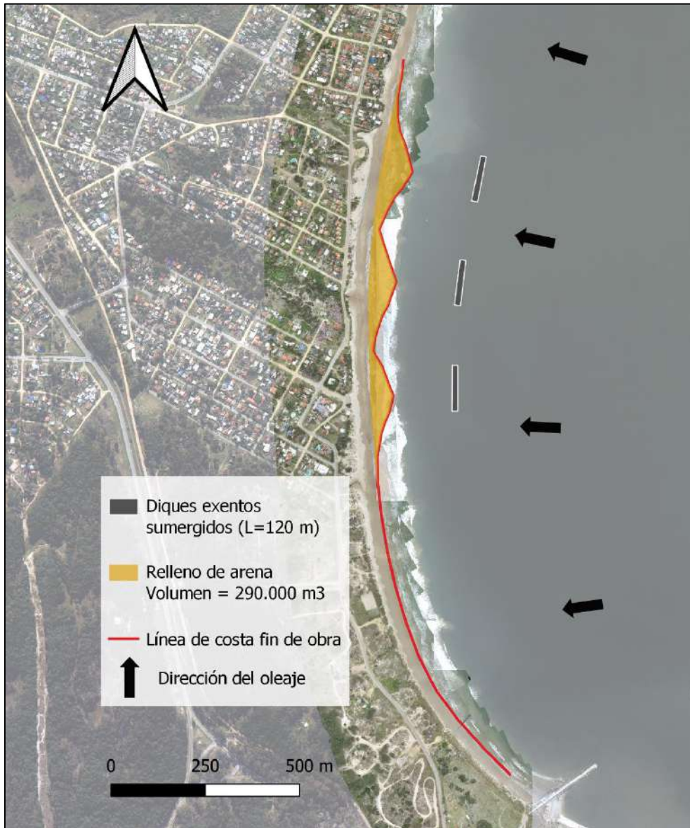
Figura 4-62 – Configuración en planta de la alternativa Norte A.4.
