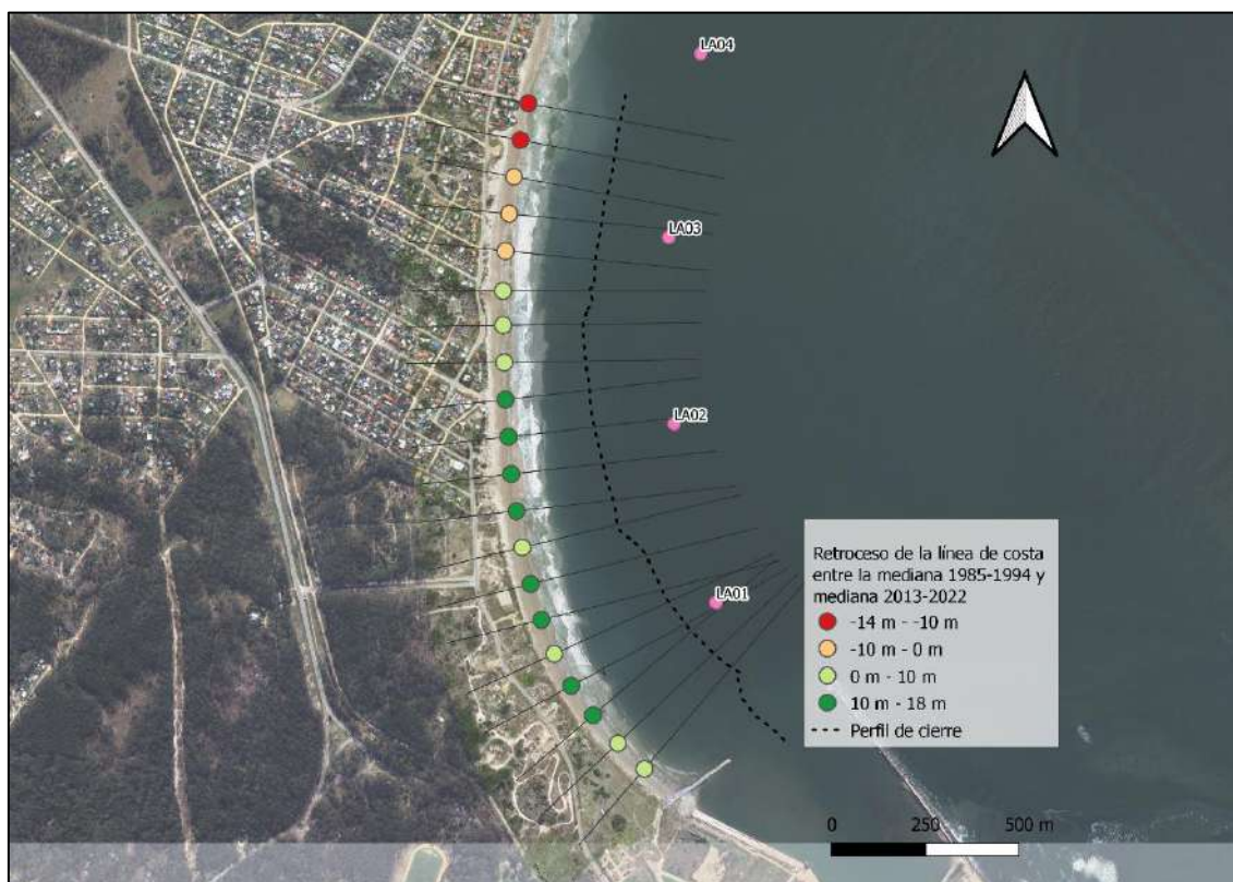
Figura 4-18 – Cambio en la posición de la línea de costa entre mediana 1985-1994 y mediana 2013-2022.
