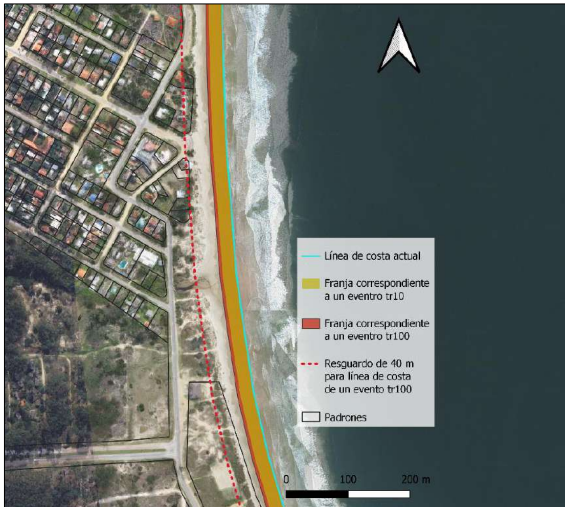
Figura 4-36 – Tramo de costa correspondiente a perfiles 7 a 14. Línea de costa actual correspondiente a la mediana 2013-2022; franja de correspondiente a evento de erosión de 10 años de período de retorno (naranja); franja correspondiente a evento de erosión de 100 años de período de retorno (amarillo); curva de margen de seguridad para ascenso y descenso del agua durante eventos de retroceso del perfil de playa (línea roja punteada).
