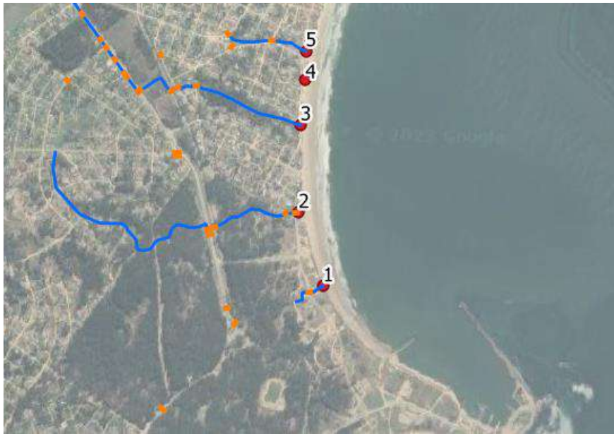
Figura 4-45. Descargas pluviales a la costa – La Aguada.
