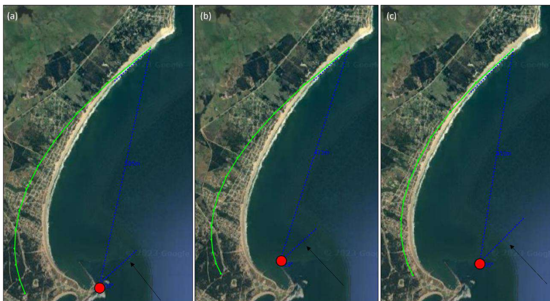
Figura 4-25 – Formas de equilibrio estático en planta a largo plazo para el arco de playa La Paloma – La Pedrera, considerando como punto de difracción del oleaje, el arranque del dique de abrigo del puerto (panel a), el morro del dique de abrigo (panel b) y la zona de bajo ubicada al Este del dique (panel c).
