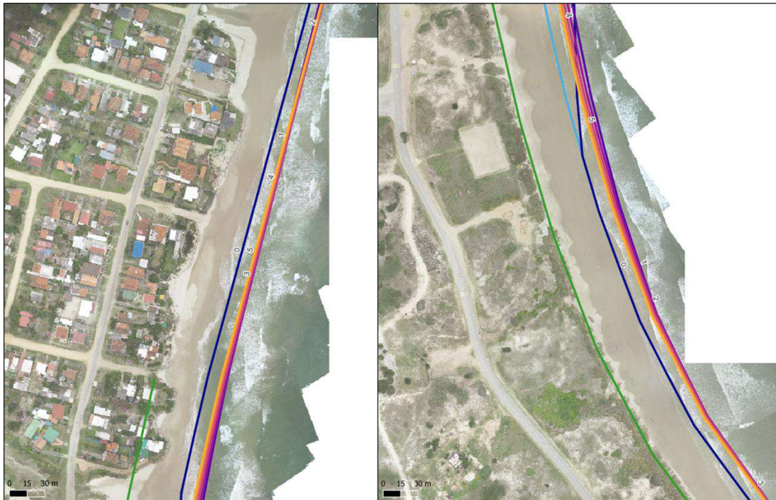
Figura 4-74 – Evolución de la línea de costa para los 5 primeros años para el caso del relleno de avance 60 m en las zonas ubicadas al norte (Costa Azul) y al sur (tramo sur de La Aguada) de la zona de interés.
