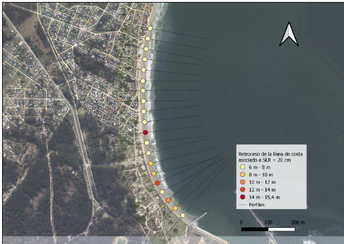
Figura 4-40 – Retroceso esperable de la línea de costa por efecto de un aumento de 20 cm del nivel medio del mar, calculado con el modelo ShoreTrans.
