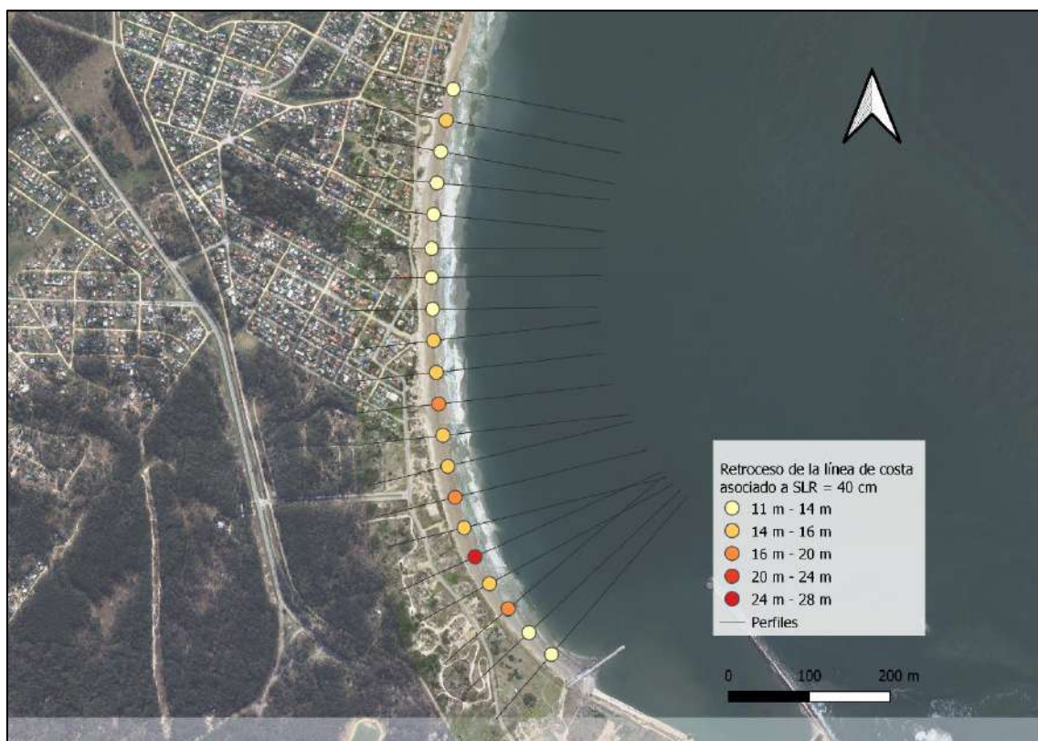
Figura 4-41 – Retroceso esperable de la línea de costa por efecto de un aumento de 40 cm del nivel medio del mar, calculado con el modelo ShoreTrans.
