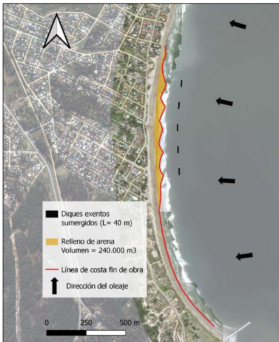
Figura 4-60 – Configuración en planta de la Alternativa Norte A.3.
