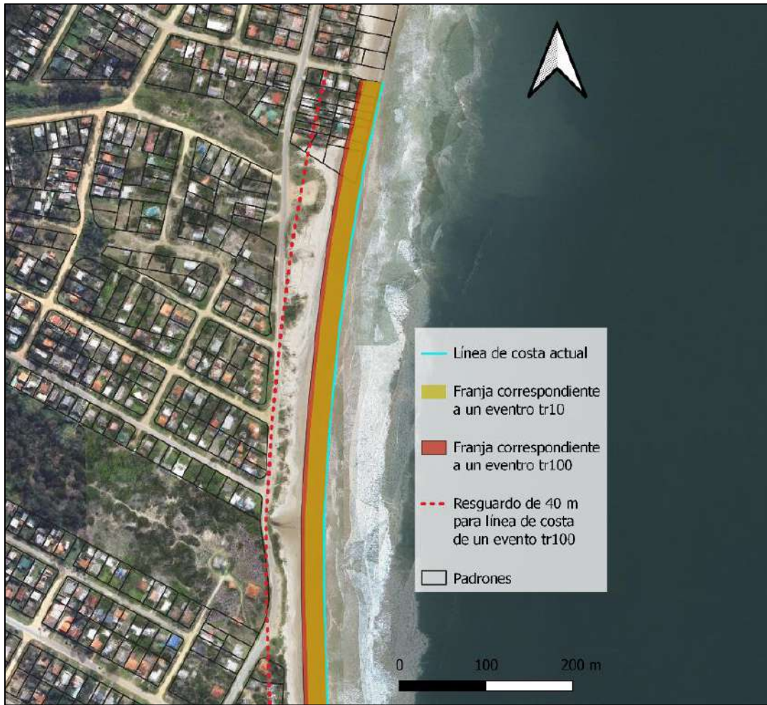
Figura 4-37 – Tramo de costa correspondiente a perfiles 14 a 20. Línea de costa actual correspondiente a la mediana 2013-2022; franja de correspondiente a evento de erosión de 10 años de período de retorno (naranja); franja correspondiente a evento de erosión de 100 años de período de retorno (amarillo); curva de margen de seguridad para ascenso y descenso del agua durante eventos de retroceso del perfil de playa (línea roja punteada).
