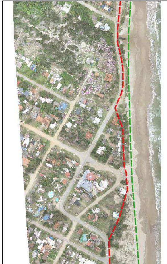
Figura 4-66 – Posición de la línea a proteger (bienes e infraestructura) y posición del pie de duna actual.
