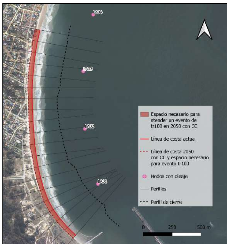
Figura 4-48 – Línea de costa proyectada para 2050, considerando aumento del nivel medio del mar de 20 cm, y franja de variabilidad del perfil de playa considerando retroceso del perfil de 100 años de período de retorno. No se incluye en esta figura el resguardo adicional de 40m.
