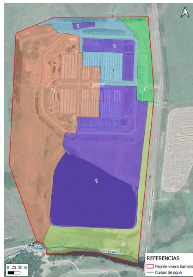
Figura 6-5: Cuencas pluviales en situación proyectada
