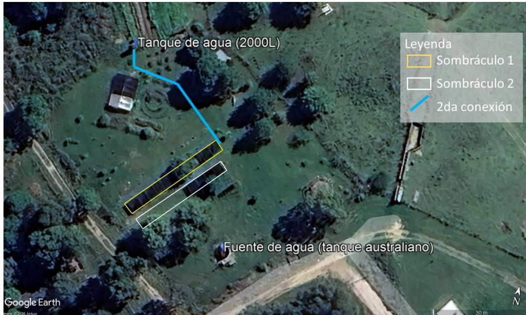
Figura 4. En línea azul se muestra el recorrido de la conexión de 1 caño que continúa desde el sombráculo hacia el tanque de agua (2da conexión).
