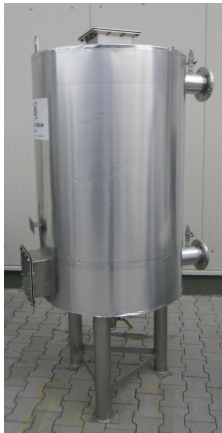
Figura 14 – Ejemplo de filtro de carbón activado para biogás (Fotografía gentileza Lanás Trinidad S.A.)
