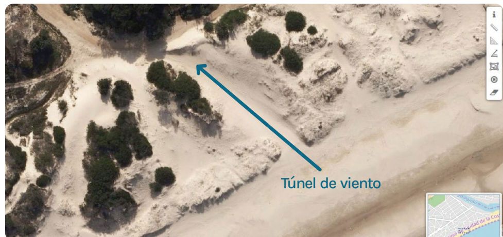
Figura 3. Túnel de viento asociado a un ingreso peatonal irregular (IDEUY 2020).
