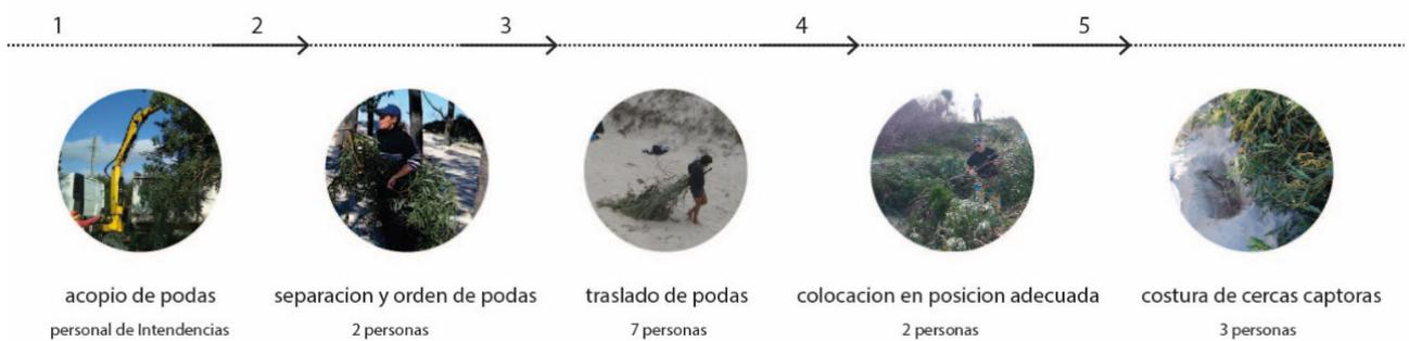
**Fig. 19** Etapas de producción de cercas captoras con previo acopio de podas
