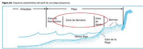
Figura 24. Esquema característico del perfil de una playa (resaca).
