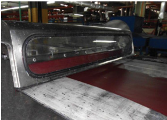
Máquina de pintado tipo cortina y rodillos. Foto: Proyecto FREPLATA
