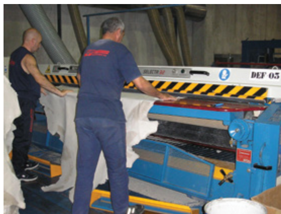
Máquina de lijado. Foto: Curtifrance S.A.
