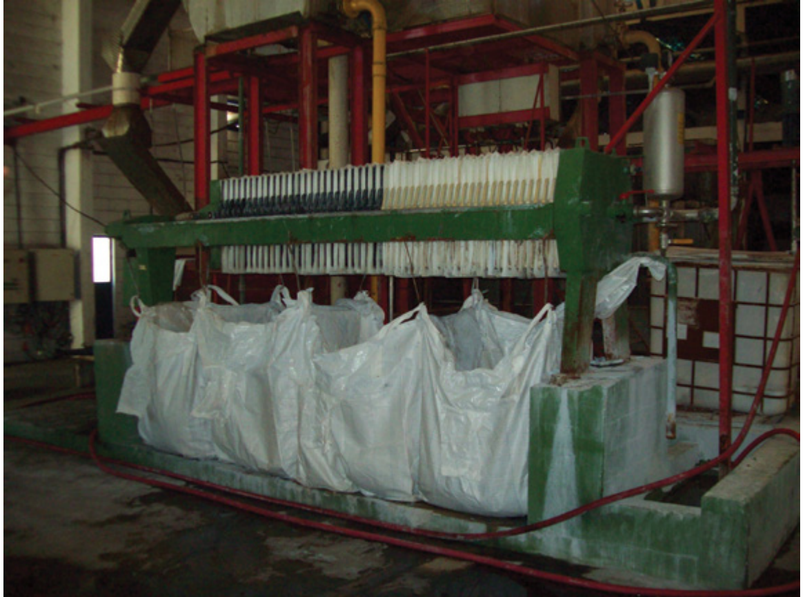
Filtro prensa para la obtención de torta de cromo. Foto: DINAMA.
