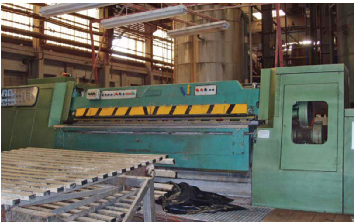
Máquina de dividir en tripa y en wet-blue. Foto: AUQTIC
