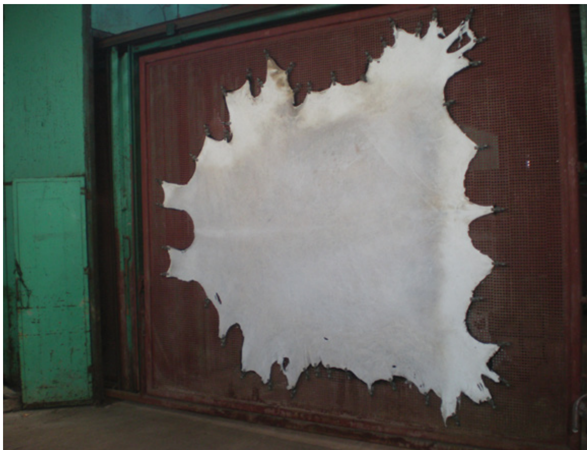
Disposición de cueros para ingresar al túnel de secado. Foto: Sistemcuer S.R.L
