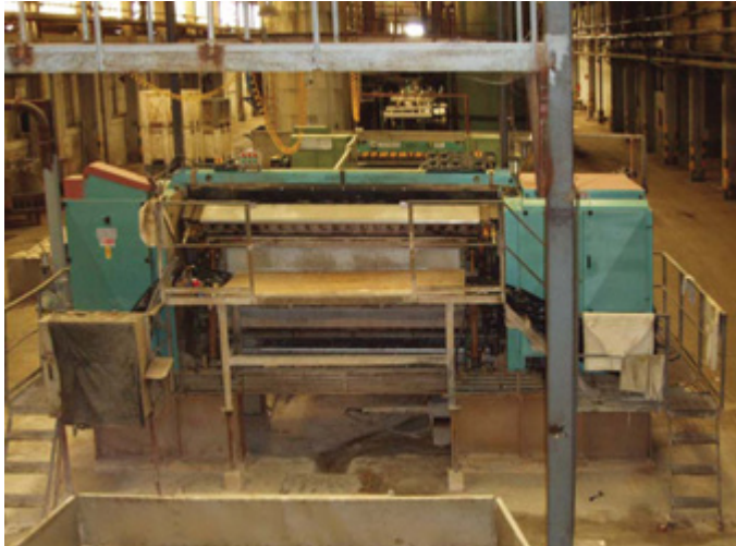
Máquina de descarnar y depósito de sebo. Foto: AUQTIC
