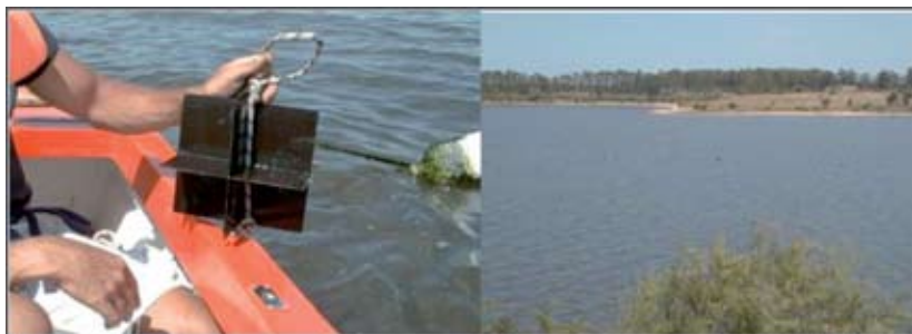
Figura 4. Paneles de incrustación y zona de incubación con boyas para la disposición de sustratos durante para el estudio de los patrones de asentamiento de Limnoperna fortunei en Embalses Palmar.
