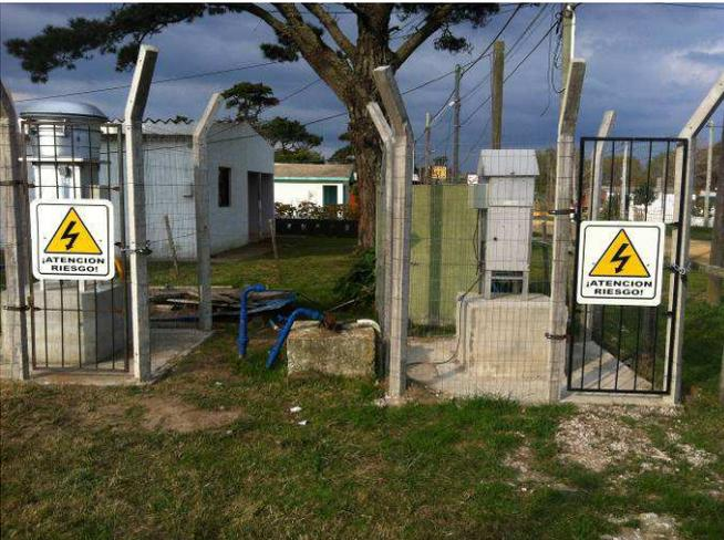
*Ilustración 3: Equipo PM10 (izquierda) y PTS (derecha)*
