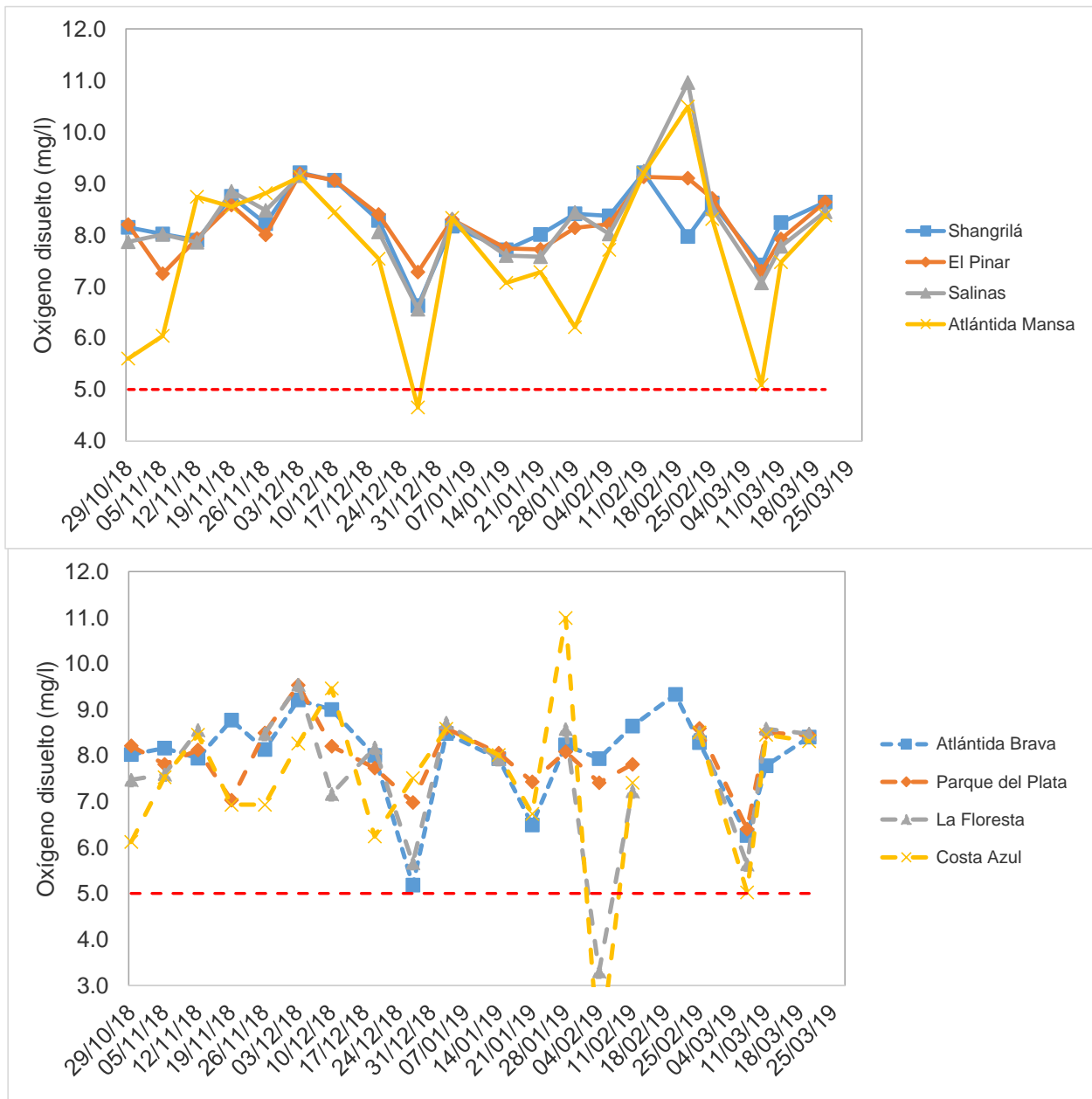
Figura 53. Variación temporal del oxígeno disuelto de las playas del Dpto. de Canelones durante la temporada 2018-2019. La línea roja entrecortada indica el mínimo valor admitido por la normativa.
