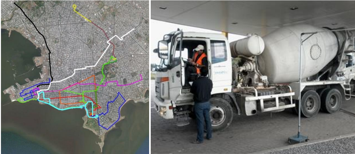
Ilustración 10: Medición de emisiones vehiculares en movimiento sobre 11 vehículos livianos (izquierda) y medición de emisiones vehiculares en ralentí sobre 119 camiones (derecha). Fuente: (D'Angelo Taibo, 2016).
