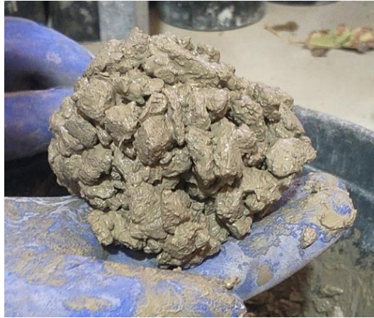
Figura 16. Mezcla de hormigón permeable con cantidad adecuada de agua.
