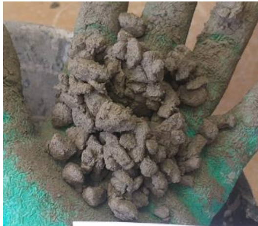
Figura 17. Mezcla de hormigón permeable con cantidad insuficiente de agua.
