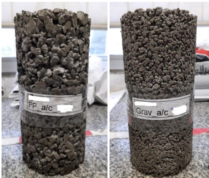
Figura 15. Probetas ( \phi 10 cm x 20 cm) de hormigón permeable con piedra partida (TMA: 14 mm) y gravillón (TMA: 10 mm) como agregado grueso.
