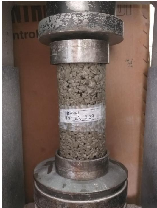
Figura 12. Probeta cilíndrica en ensayo de resistencia a la compresión.
