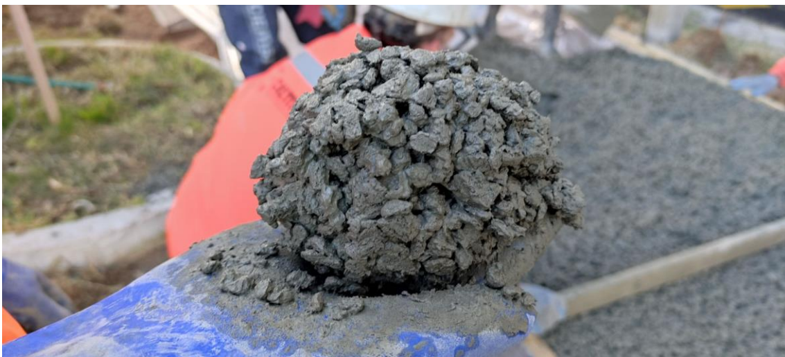
Figura 8. Apariencia del hormigón permeable en estado fresco.
