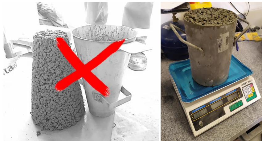
Figura 23. Ensayo del cono de Abrams en hormigón permeable (no recomendable como control de recepción), y ensayo de densidad en estado fresco (ensayo recomendado).
