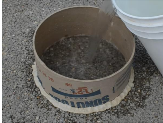
Figura 31. Ensayo de tasa de infiltración según ASTM C1701. (Imagen extraída de www.youtube.com/watch?v=skYLOqmw0yo / Sin copyright)
