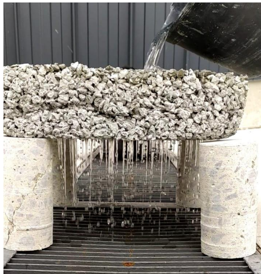
Figura 2. Loseta demostrativa de hormigón permeable filtrando agua.
