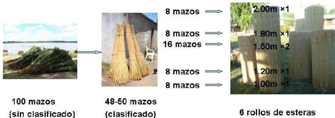
Figura 44: 100 mazos se puede producir 6 rollos de esteras
