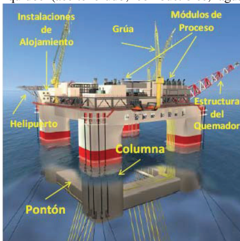
Figura 2. Componentes principales del topside y del casco de una plataforma Semisumergible.
