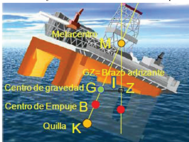
Figura 4. Parámetros de estabilidad hidrostática en un sistema flotante.
