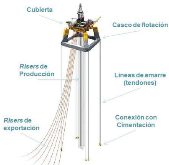
Figura 1. Componentes principales de un sistema flotante.
