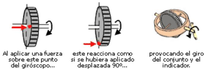
**Fig.2.8.4 - Funcionamiento del indicador de viraje.**
