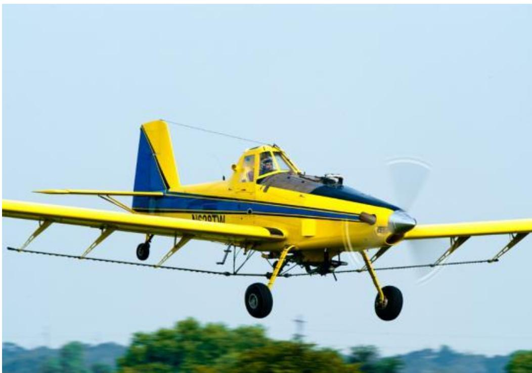
Es uno de los aviones más populares, específicamente diseñado para tareas de aeroaplicación, mono turbohélice, monoplaza, con tren de aterrizaje del tipo convencional fijo, de construcción totalmente metálica, con un total de más de 600 unidades fabricadas desde 1987, el AT-502B tiene una capacidad de 1.893 litros (500 galones) para reducir la cantidad de viajes de regreso al campo, lo que se traduce en menor cantidad de aterrizajes y despegues.
