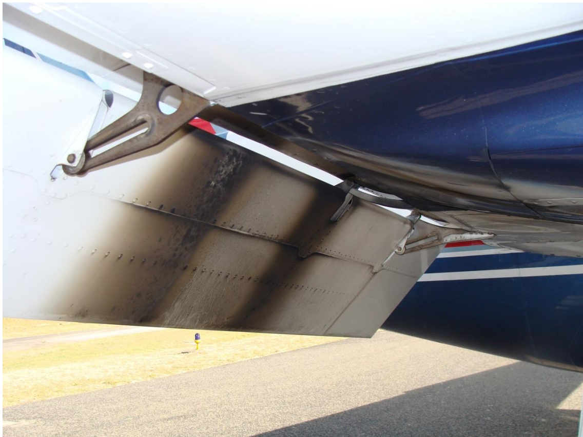
Detalle del flap derecho con hollín a ambas lados de salpicaduras del agente extintor
