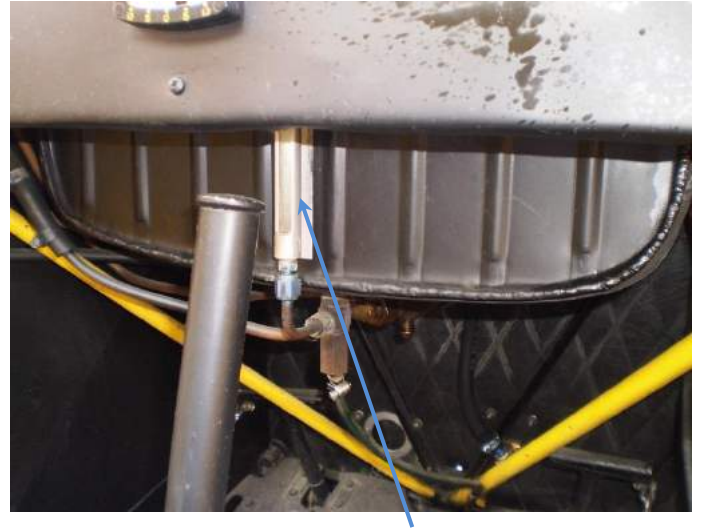
FOTO 2 INDICADOR DE NIVEL DE CANTIDAD DE COMBUSTIBLE DE FUSELAJE
