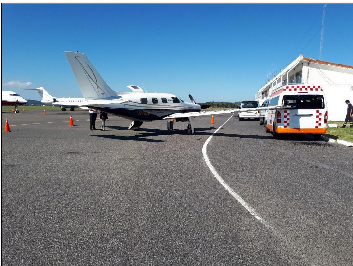
En la imagen se aprecia la desviación de la aeronave respecto a la línea marcada en la plataforma y como colisiono con su ala derecha el vehículo estacionado
