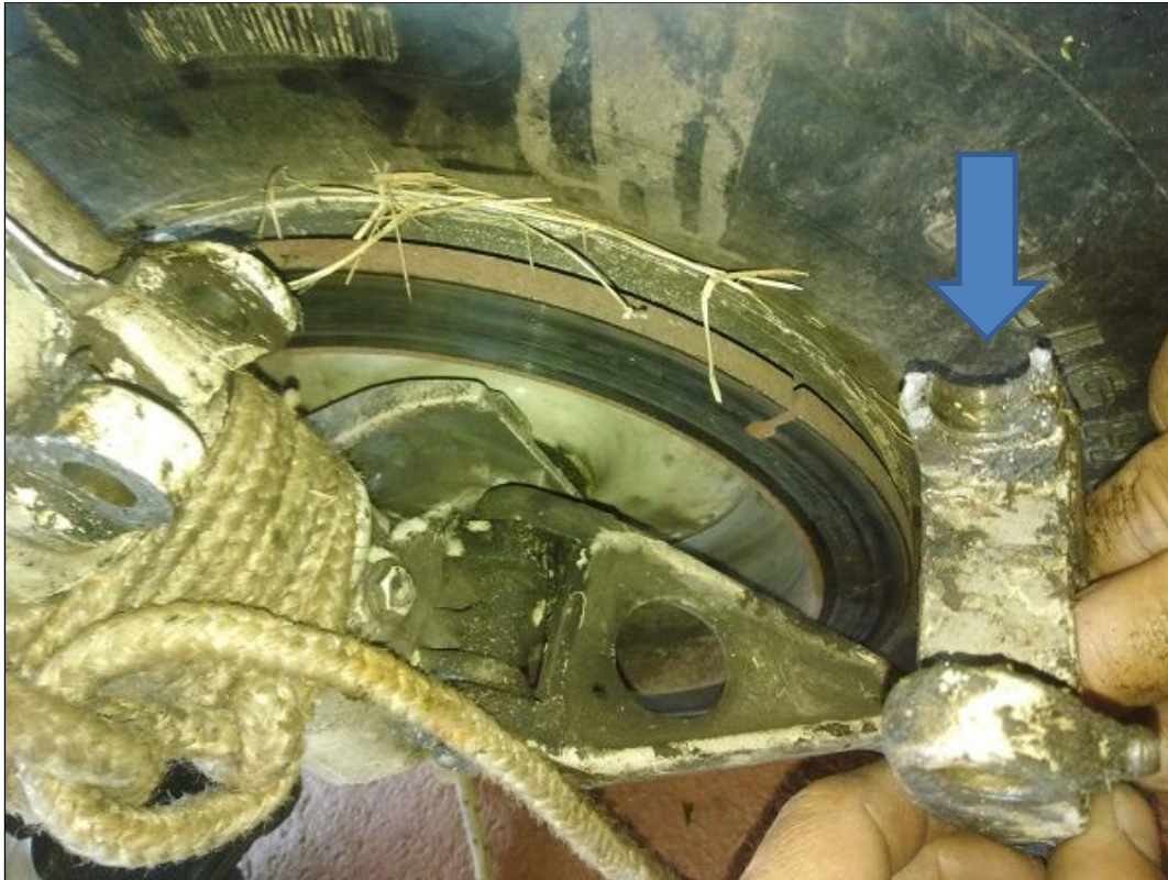
Foto 8. Se aprecia la rotura del punto de sujeción de la tijera o TORQUE LINKS al strut principal.
