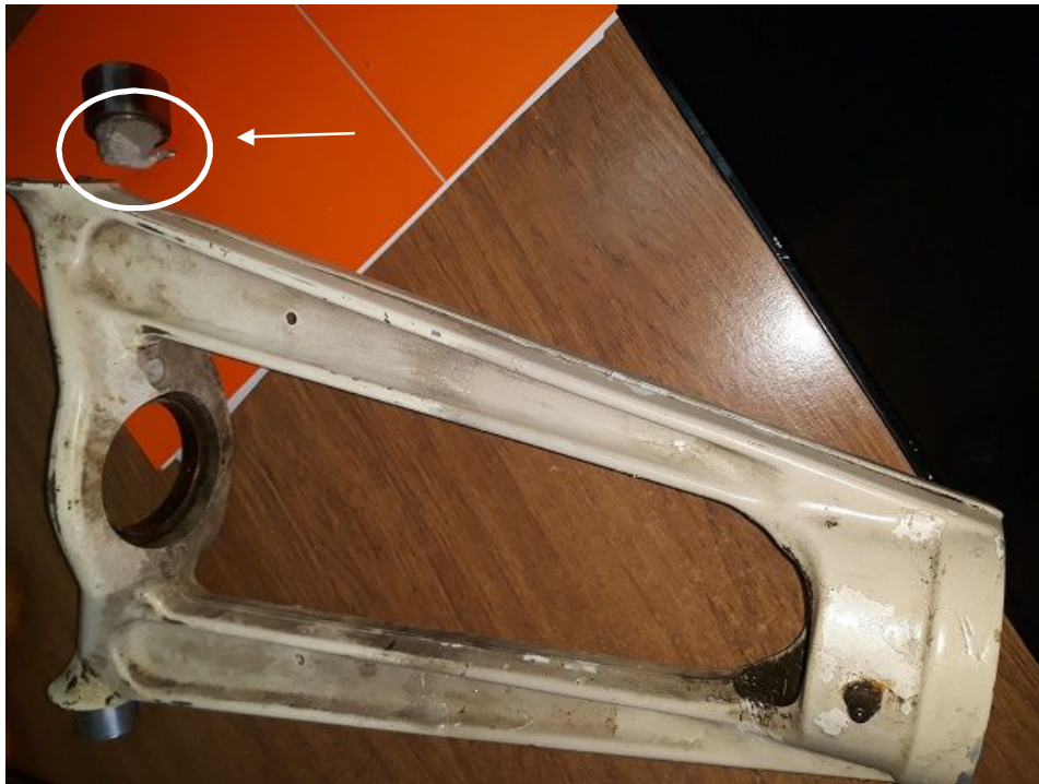
Foto 8. Se aprecia la fractura del punto de sujeción del tren de nariz.
