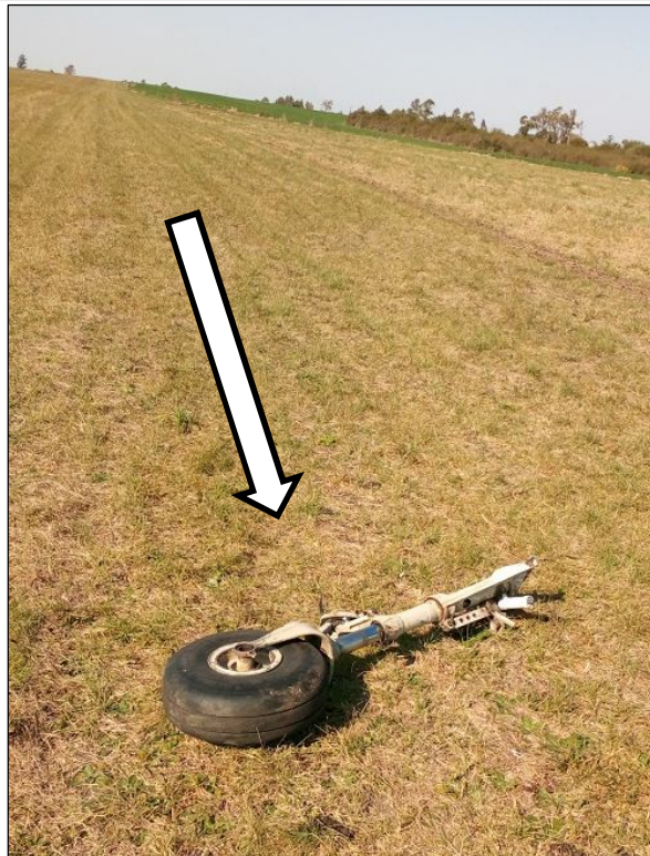
Foto 6. La flecha indica el derrape de la rueda del tren de nariz y la posición final luego de su desprendimiento.
