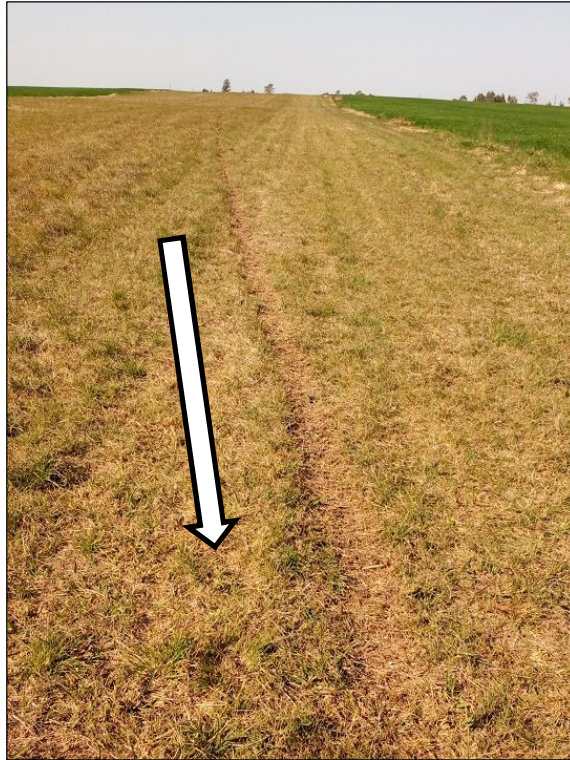
Foto 5. Se observa el derrape de la rueda del tren principal izquierdo.
