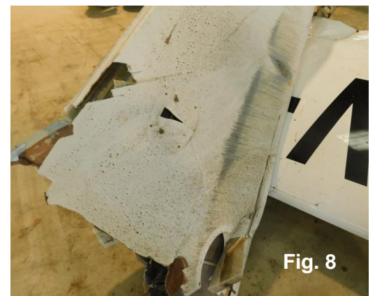
Fig.4 posición 3: contacto del ala derecha, quebrando hacia arriba con marcas de abrasión (Fig. 8).
