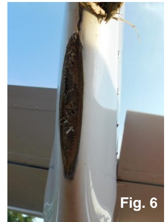
Fig. 4, posición 1: huellas encontradas en la pista, correspondiendo 1ero., al arrastre del taco de sujeción de cola (Fig. 5) y luego a la parte inferior de la cola (Fig.6).
