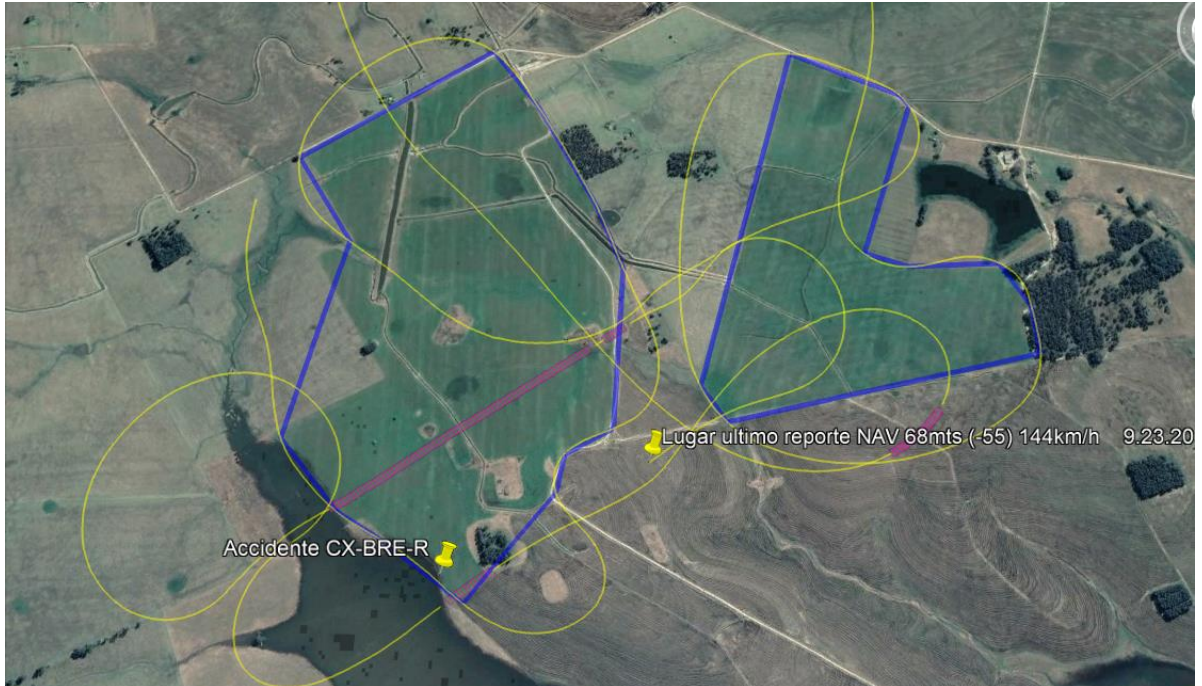
Imagen 14: Puntos de pérdida de datos del GPS y de la posición final de la aeronave.
