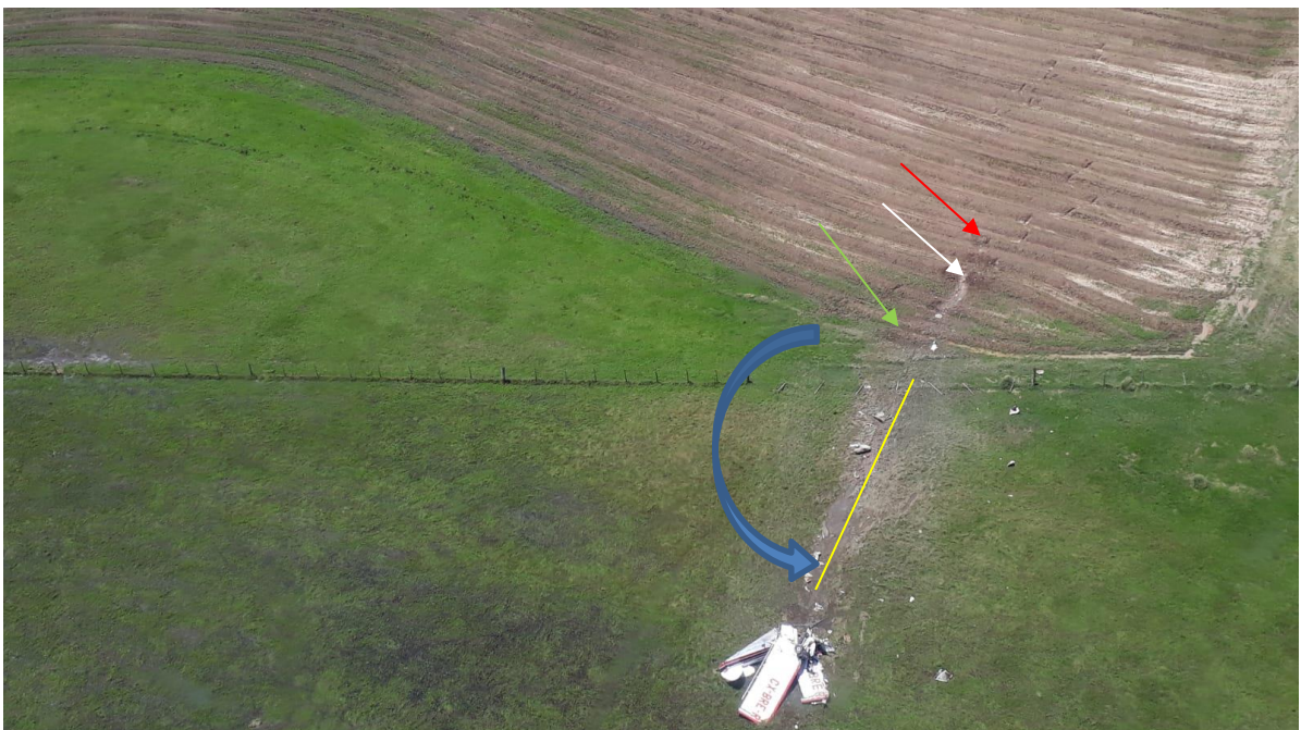
Imagen 22: Vista aérea de la zona de impacto; flecha roja: toque tren derecho; flecha blanca: toque de hélice; flecha verde: toque ala derecha y comienzo de su deslizamiento sobre el suelo.
