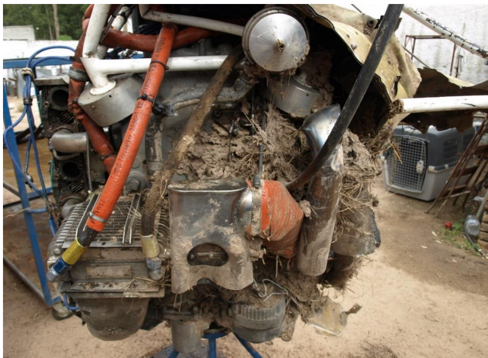
Imagen 18: Vista de la parte inferior del motor; éste se encuentra apoyado sobre la sujeción de la hélice.
