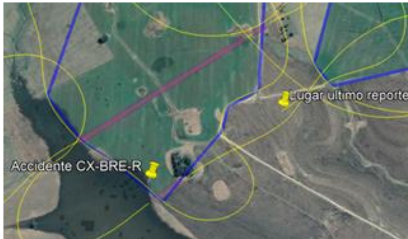
Imagen 15: Puntos de pérdida de datos del GPS y de la posición final de la aeronave; nótese el monte ubicado entre ambos puntos y en cuerpo de agua en cuyo límite ocurrió el accidente.
