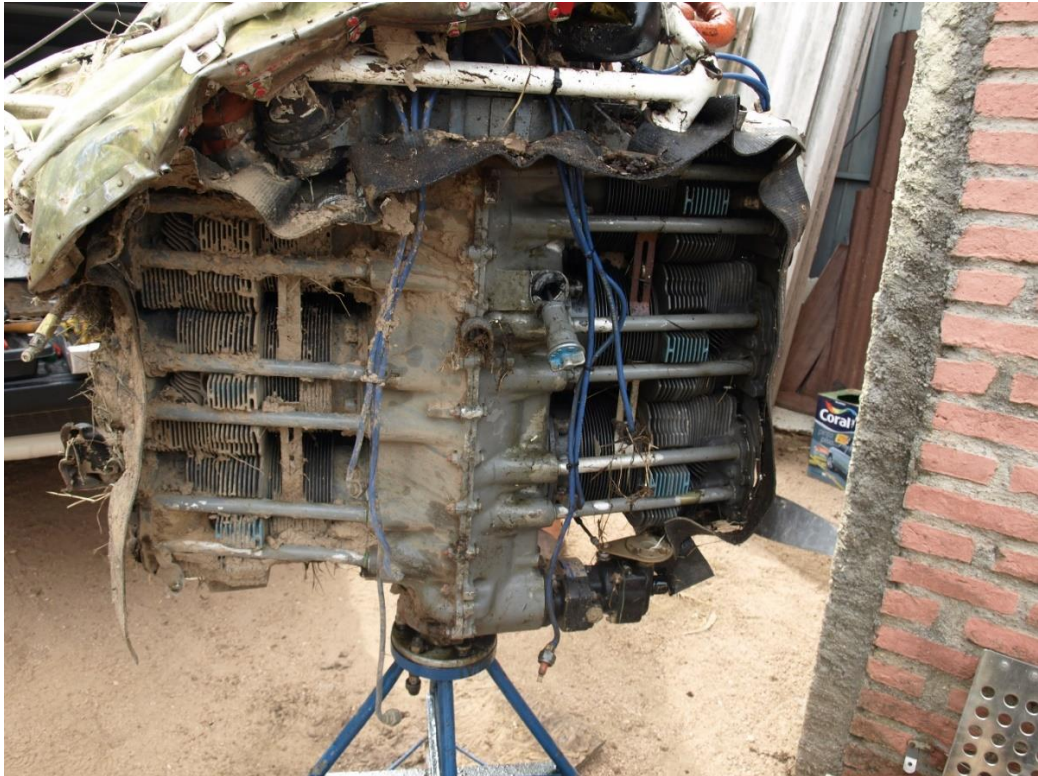
Imagen 19: Vista de la parte superior del motor; éste se encuentra apoyado sobre la sujeción de la hélice.
