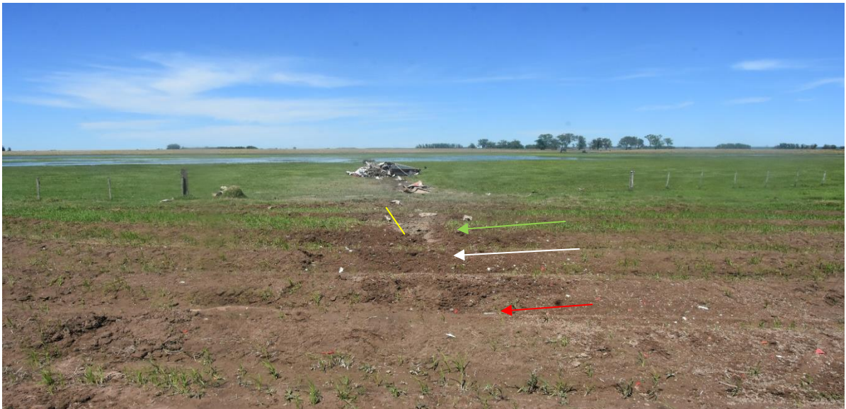
Imagen 21: Con la línea de vuelo por detrás del fotógrafo y la línea de desplazamiento sobre el terreno registrada en la imagen, las flechas de colores indican los puntos de contacto contra el suelo.
