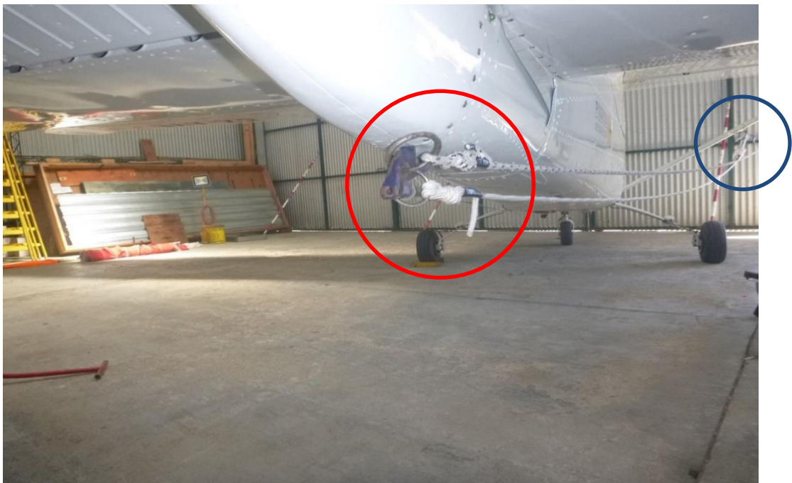
Imagen 5. Sistema de sujeción a la aeronave (círculo rojo) y garfios asegurados al parante (círculo azul)
