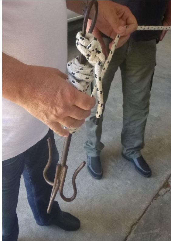
Imagen 6. Muestra de la colocación de la cuerda que une al garfio con el punto de sujeción, la misma se enrolla en el garfio y al liberarlo ésta se desenrolla.
