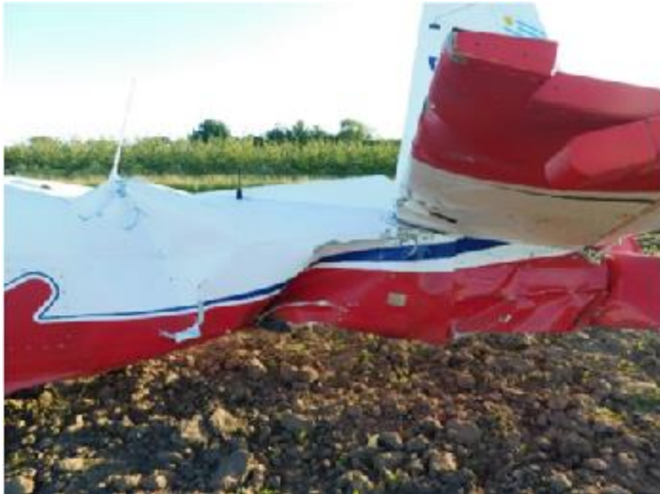
Imagen 15: detalle de los daños de la parte trasera de la aeronave
