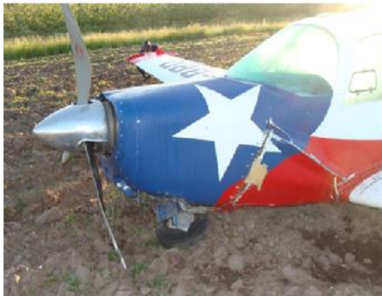
Imagen 14: detalle de los daños de la parte frontal de la aeronave.
