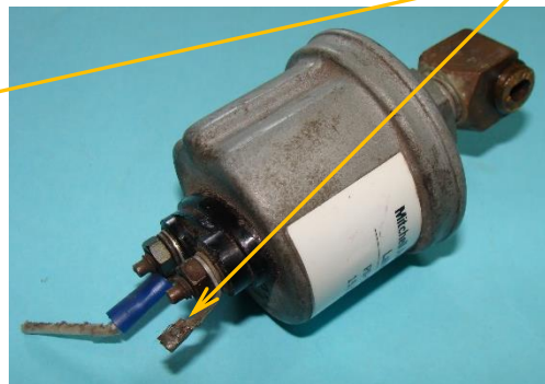
Imagen 7: sensor de presión de combustible; las flechas indican el cable zafado.
