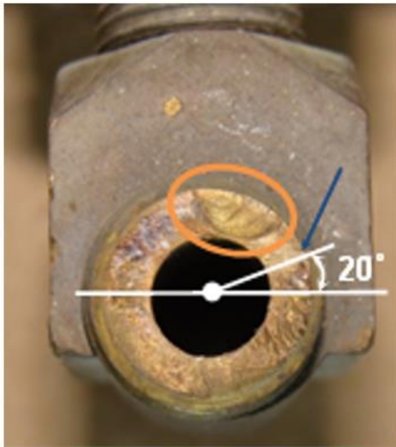
Imagen 21: fractura del niple de conexión del sensor de presión de combustible, donde puede apreciarse en el óvalo naranja la zona de fatiga, provocado por la palanca de la masa del sensor generada por la posición de instalación.
