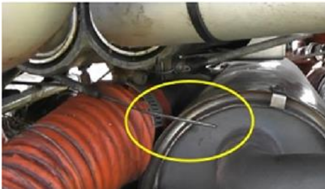
Imagen 8: el óvalo indica el extremo del cable de accionamiento del control de mezcla.
