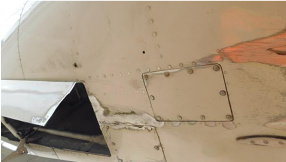
Imagen 14. Vista lateral izquierda, con las abrasiones generadas en la compuerta del tren de nariz.
