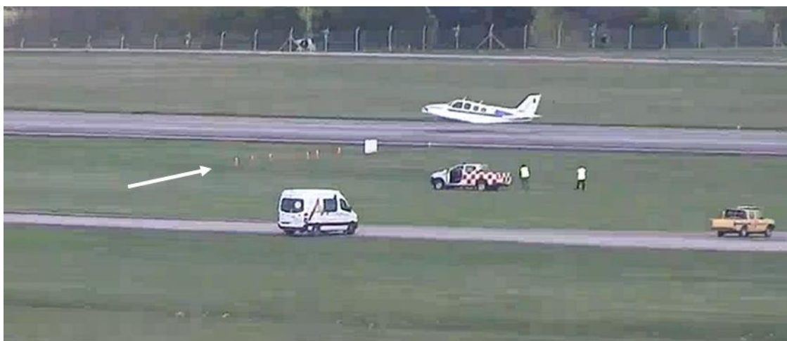
Imagen 11. Puede verse a la aeronave próxima a realizar el contacto con la pista; la flecha indica la línea de conos colocados por el explotador del aeropuerto, a los efectos de que la aeronave aterrizara luego de ellos, en la franja verde de la pista.
