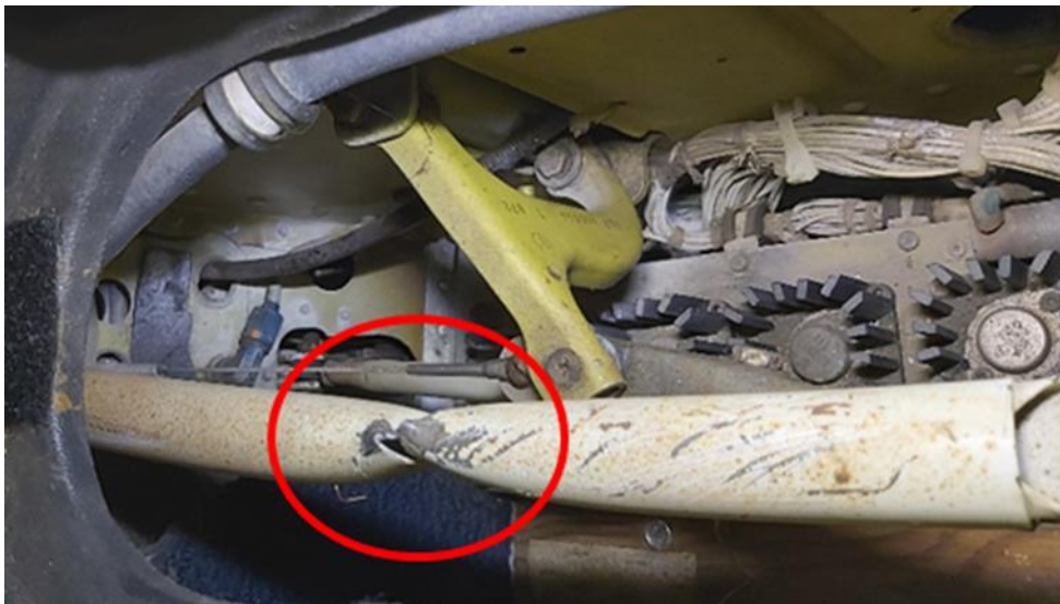
Imagen 14. El óvalo rojo señala el daño sufrido por el tubo de empuje/tracción del sistema de extensión/retracción del tren de aterrizaje principal izquierdo.
