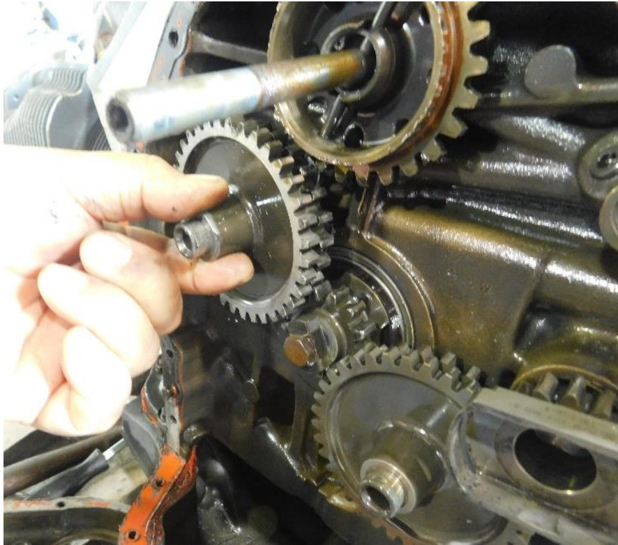
Imagen 11. La mano sostiene el vástago y engranajes intermedios que generaron la detención del motor al verse desplazados de su posición.
