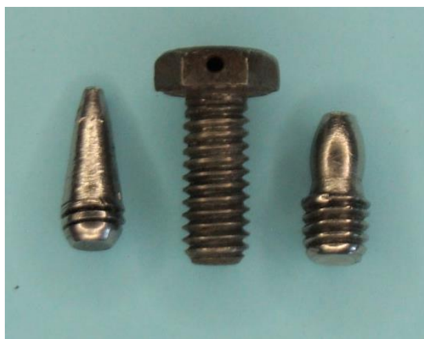
Imagen 10. Al centro puede verse un bulón en buen estado, mientras que a los lados se muestran las dos piezas que originalmente eran los dos bulones que sujetaban el vástago izquierdo.
