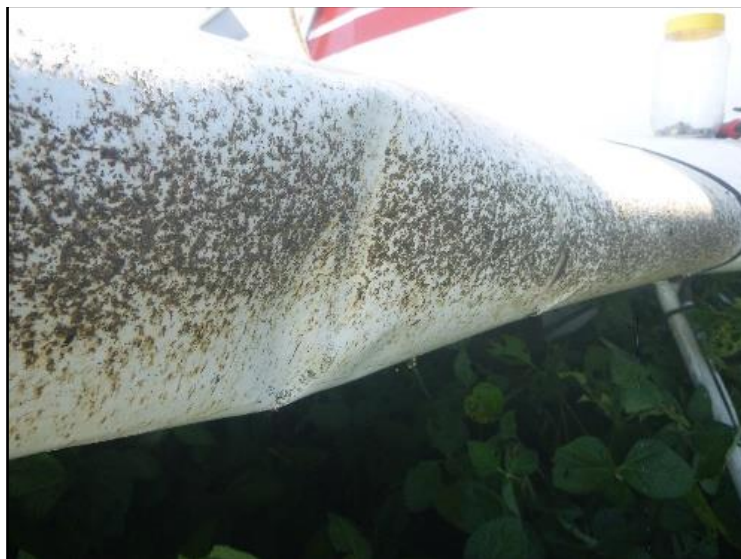
Imagen 8. Detalle de la deformación del borde de ataque derecho generada durante el aterrizaje.
