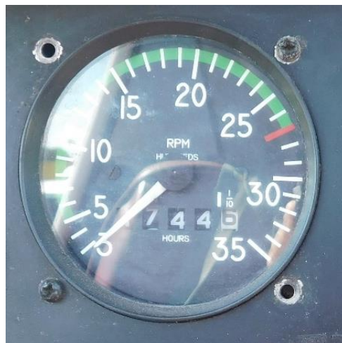
Imagen 5. Indicador taquímetro que se encontró instalado en la aeronave; este instrumento corresponde al tipo de motor instalado, el cual difiere su límite de operación máxima respecto del modelo indicado por el fabricante. La indicación del hodómetro del taquímetro era de 1744.6 hs.
