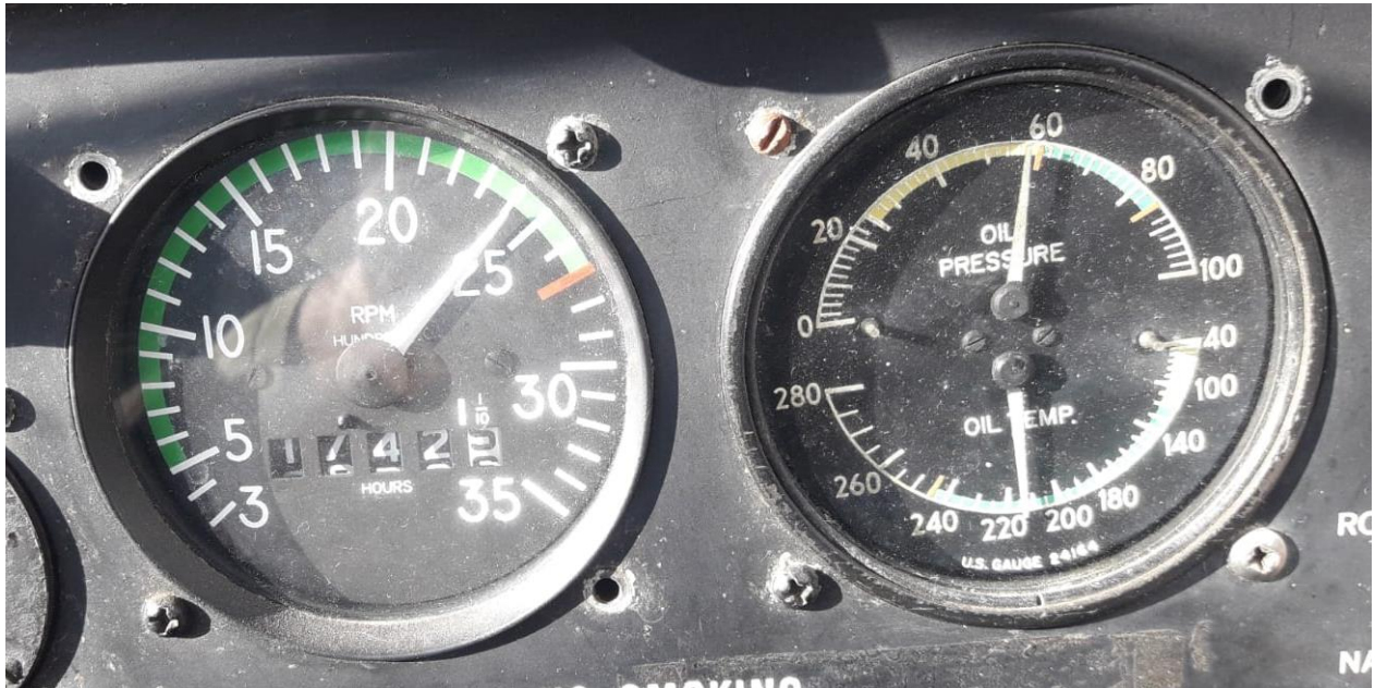
Imagen 5. Indicación de baja presión de aceite, 2.1 hs de taquímetro antes del suceso; imagen provista por el piloto de la aeronave.
