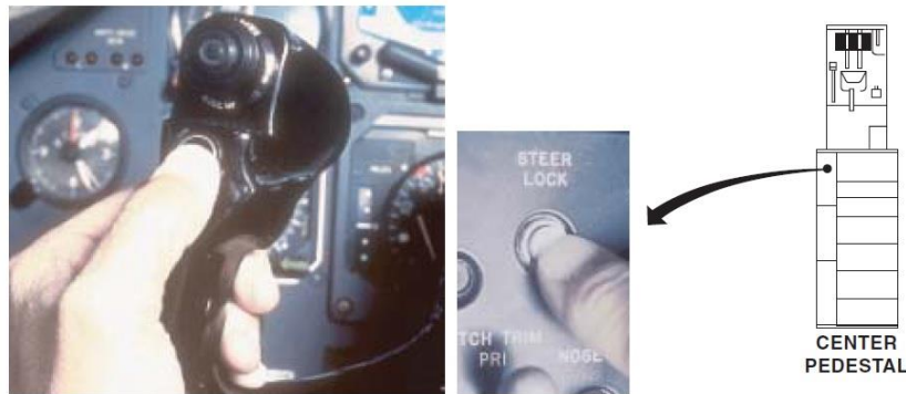
Imagen 9. Vista del Control Wheel Master Switch a la izquierda y a su derecha el Steer Lock Switch.
