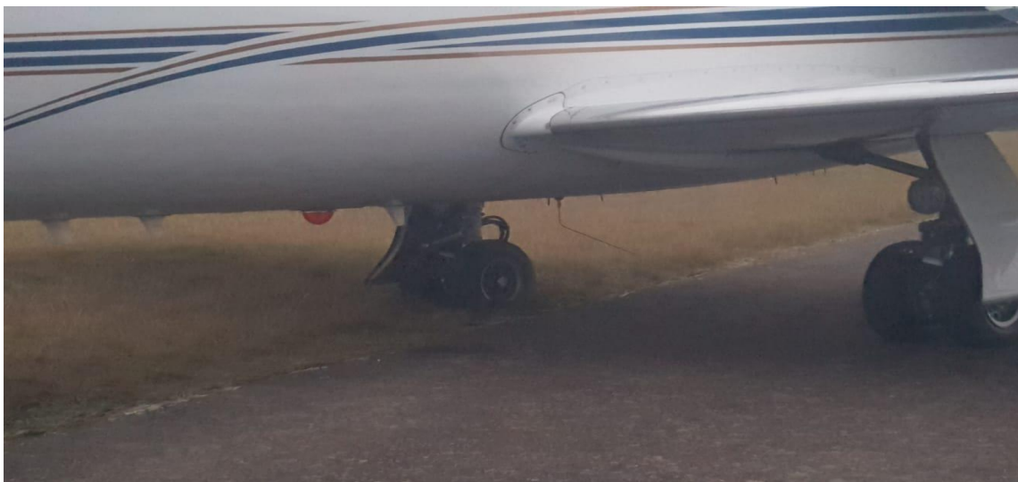
Imagen 6. Vista del tren principal derecho fuera de la calle de rodaje.
