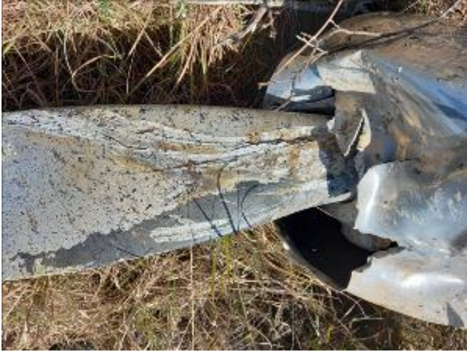
Imagen 16. Parte de los daños sufridos por la hélice.
