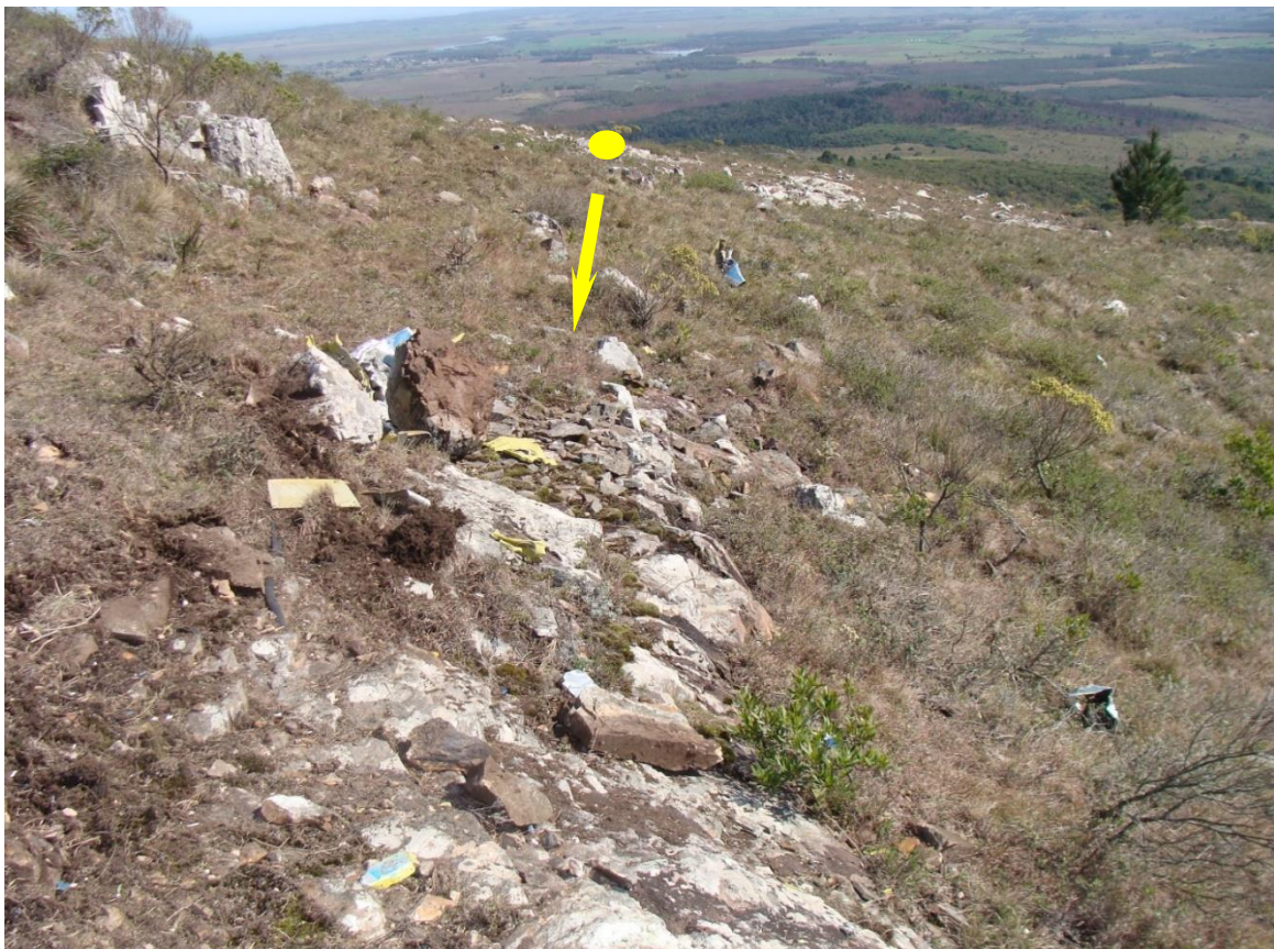
Imagen 13. El punto amarillo indica el comienzo de las huellas, y la flecha amarilla muestra la dirección de arrastre de la aeronave sobre las piedras; las rocas al frente son el sitio donde se fracturó la viga del ala.
