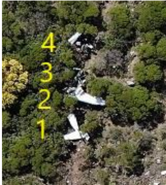
Imagen 12. El punto 1 señala la posición final del cono de cola y el empenaje; el 2 el ala izquierda; el 3 los restos de la cabina; el 4 el motor con el panel de instrumentos.
