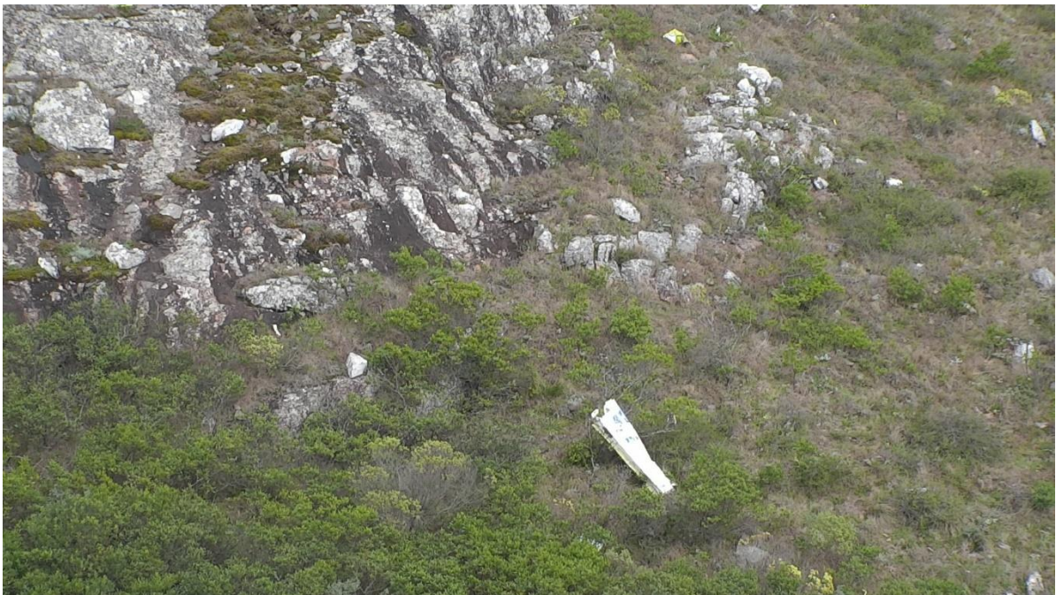
Imagen 17. Punta de ala derecha, desprendida en el momento en que se quiebra la viga del ala; fue encontrada cerro abajo, a la izquierda de la trayectoria de las marcas sobre el terreno.
