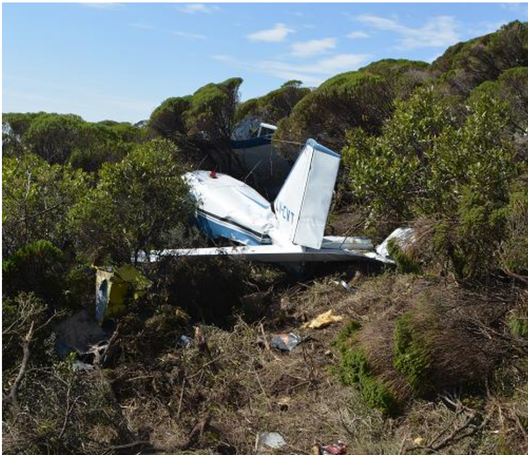
Imagen 19. Cono de cola y empenaje; más adelante se encuentra el ala izquierda y fracción de la cabina; visto desde ladera abajo.
