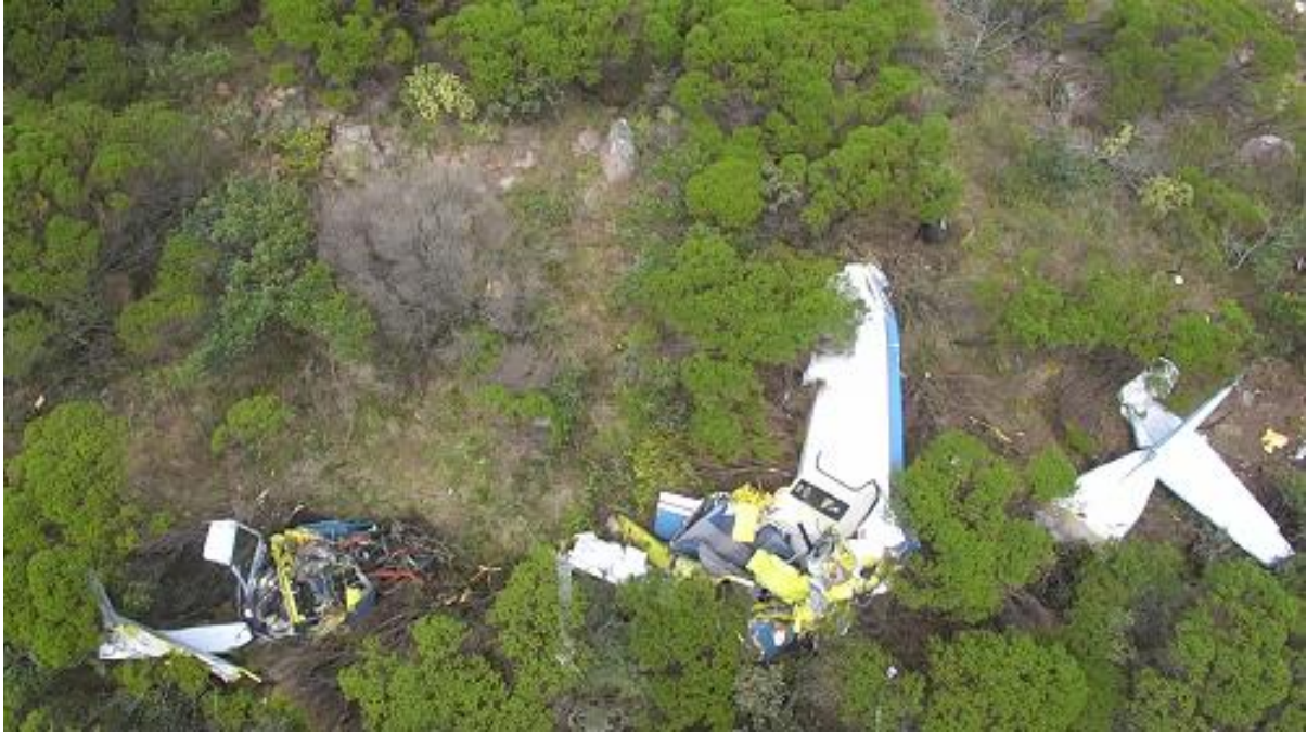
Imagen 18. Restos principales; desde la izquierda y en descenso por la ladera del cerro: fracción de la cabina adosada al motor, restos de la cabina y ala izquierda; cono de cola y empenaje.
