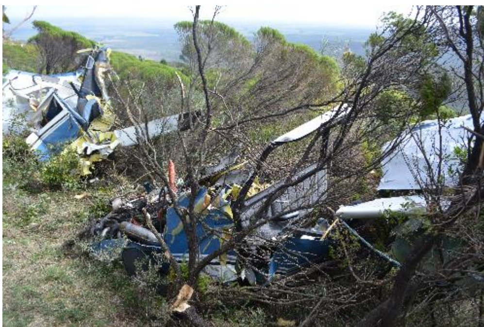
Imagen 21. Vista del motor y sus restos asociados en primer plano; al fondo y a la izquierda pueden verse restos de la cabina destruida y el ala izquierda.
