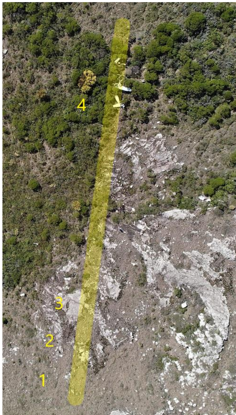
Imagen 11. La línea amarilla indica la trayectoria donde fueron descubiertos los restos, contando con 130 metros de largo; 1 indica el primer contacto con el terreno; 2 indica el golpe donde se fractura la viga del ala, se desprende la hélice y el ala derecha; 3 indica la zona donde se encontró la hélice; 4 indica la zona de los restos principales. La ladera del cerro ascendía hacia la parte superior de la foto y hacia la derecha de la misma.
