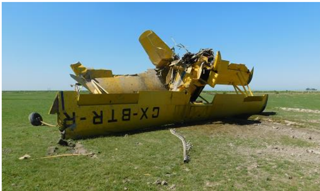
Imagen 8. Vista de la parte superior de las alas; al centro puede verse la barra de aspersión desprendida de su sujeción.
