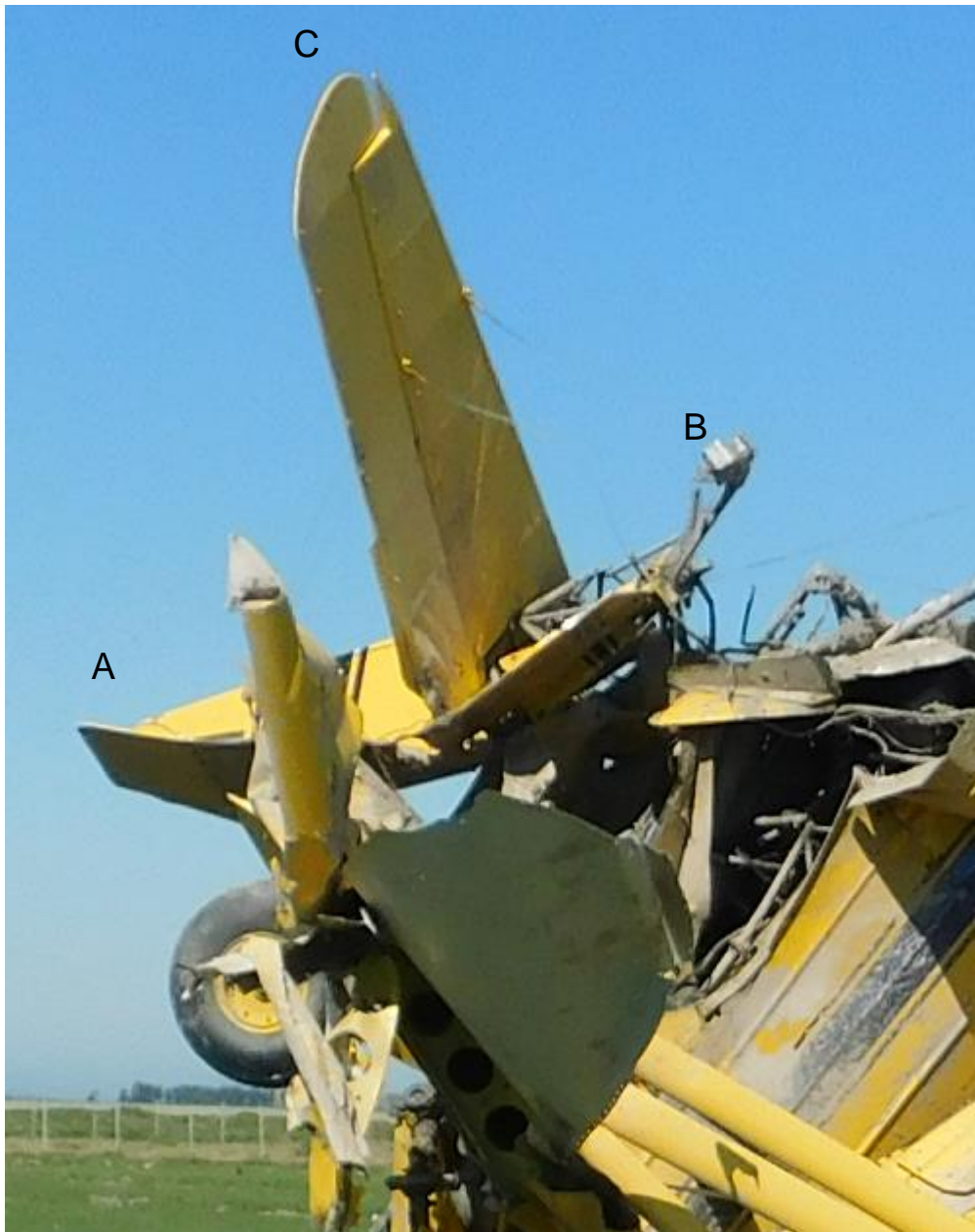
Imagen 9. Vista del empenaje, donde "A" es la punta izquierda del estabilizador horizontal, "B" su punta derecha, y "C" la punta superior del estabilizador vertical.
