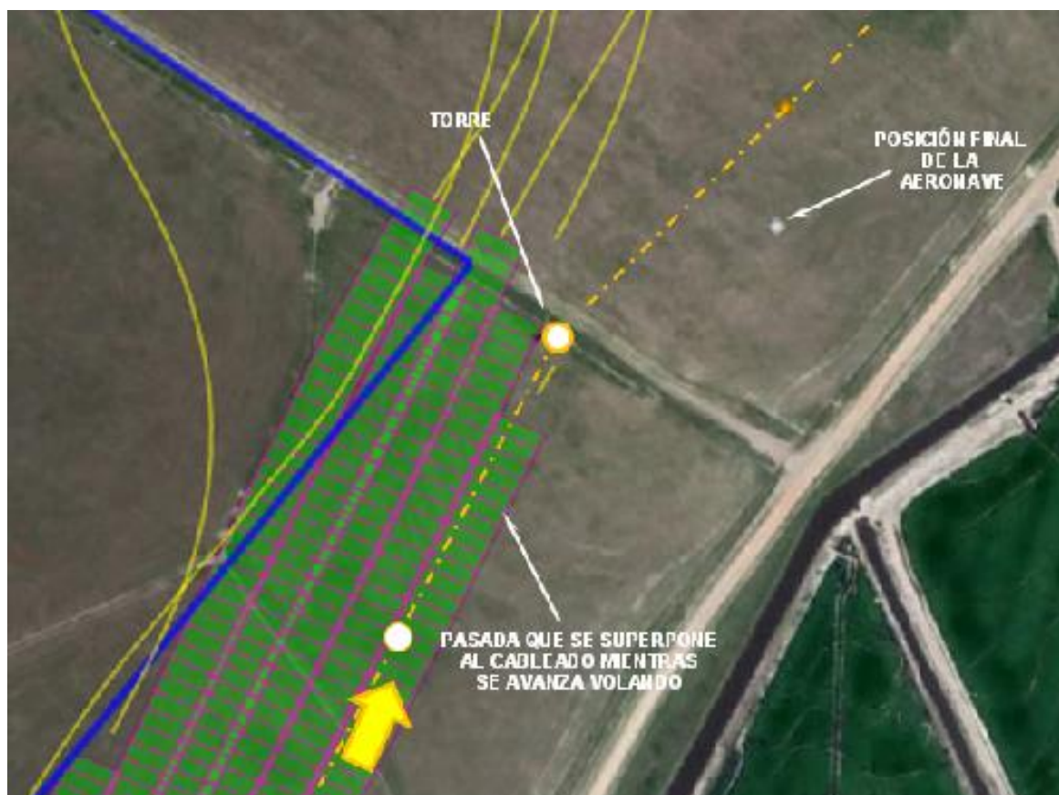
Imagen 4. Última pasada de aplicación; la flecha amarilla la señala e indica la dirección de vuelo; puede verse como la pasada se superpone con la línea de cables; se señala la última torre antes del cambio de dirección de las líneas; se identifica la posición final de la aeronave.
