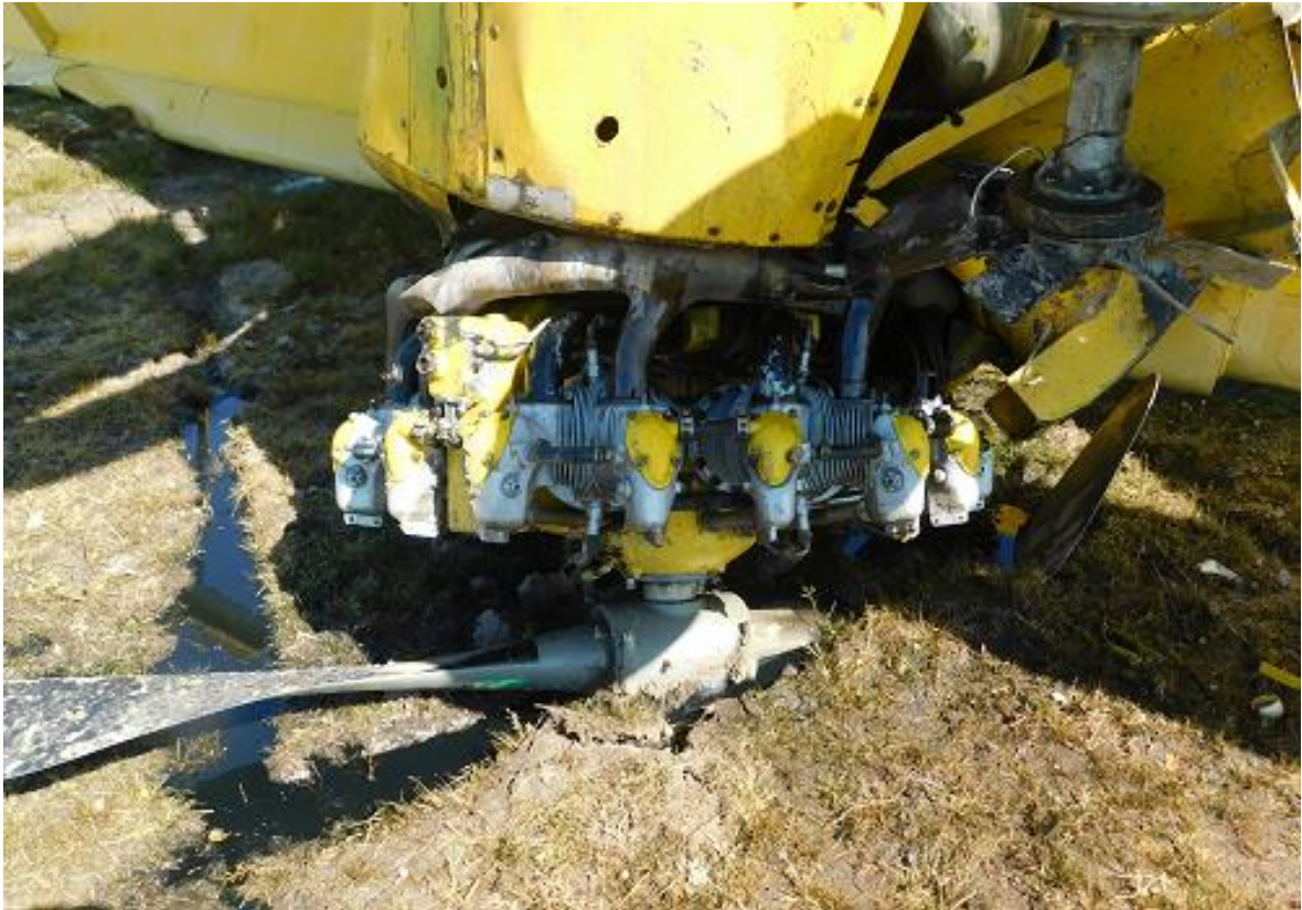
Imagen 10. Vista del motor con la hélice enterrada.
