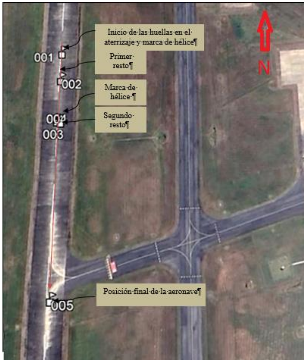
Imagen 8. Contactos con el suelo y posición final de la aeronave.
