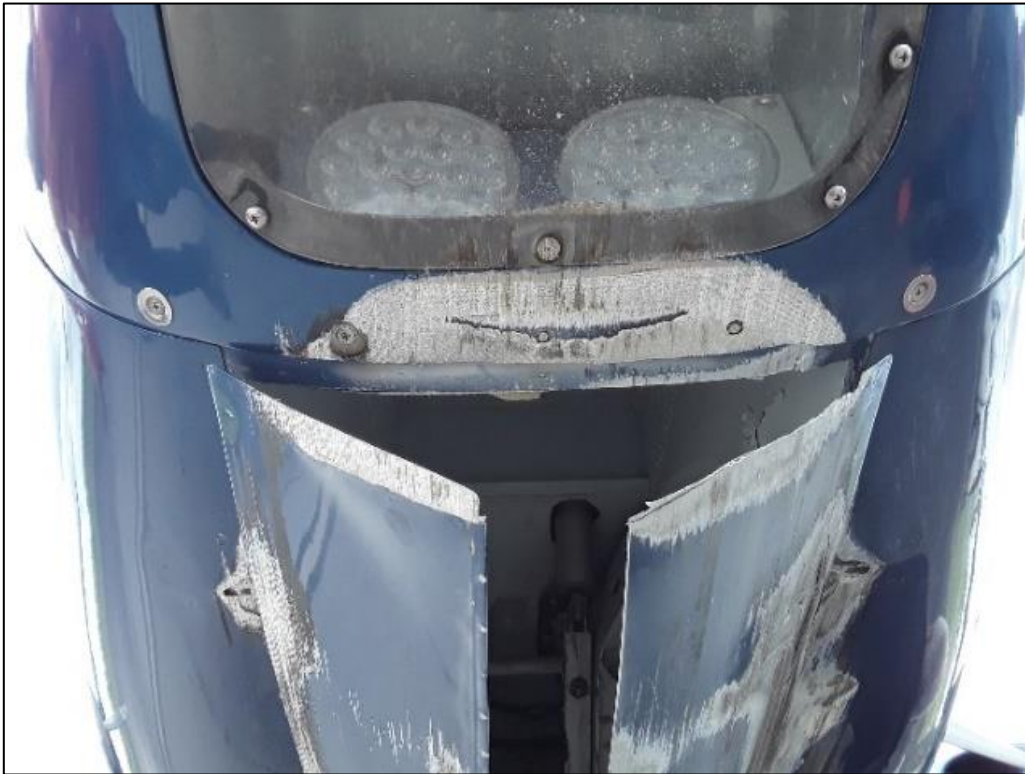
Imagen 3. Parte delantera del alojamiento del tren de aterrizaje de nariz y sus daños.
