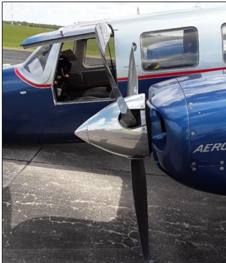
Imagen 4. Hélice izquierda, con sus puntas de pala dobladas.
