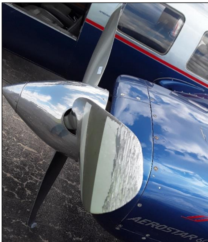
Imagen 4. Detalle del daño en las puntas de pala de la hélice izquierda.
