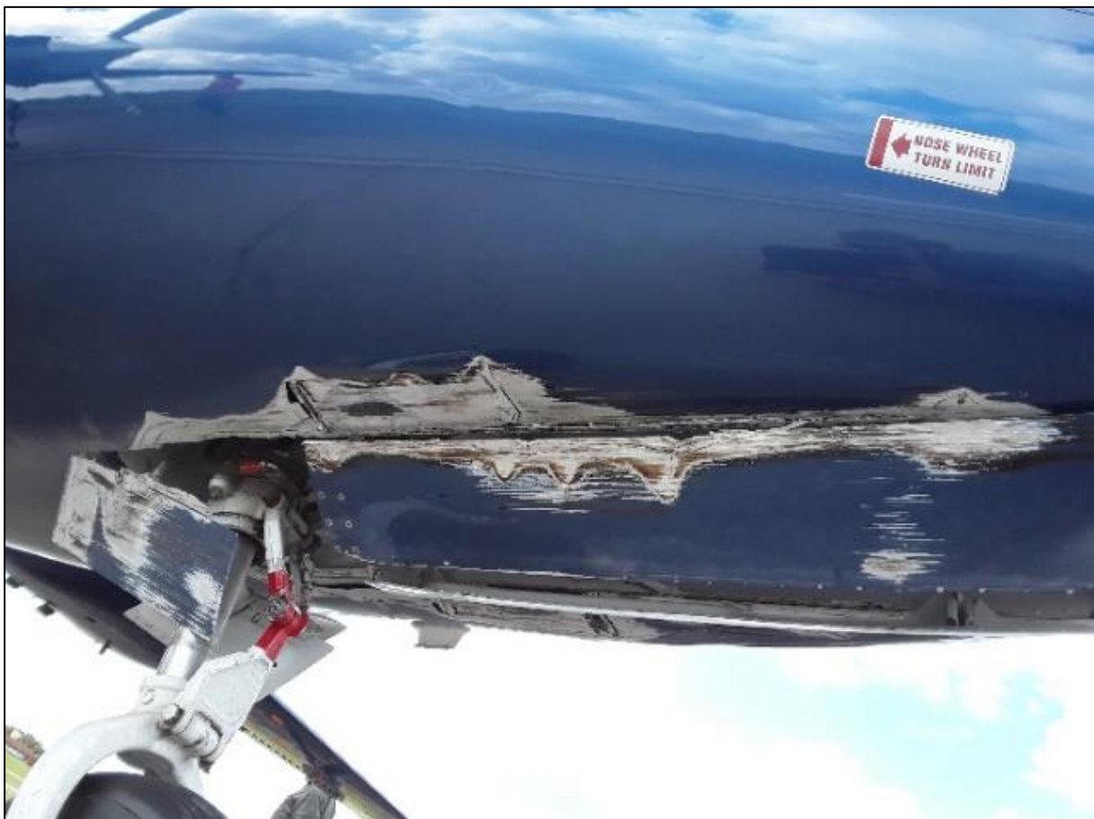
Imagen 2. Nótese pierna de nariz extendida a la izquierda, encontrándose la nariz del avión hacia la derecha; daños ocurridos.
