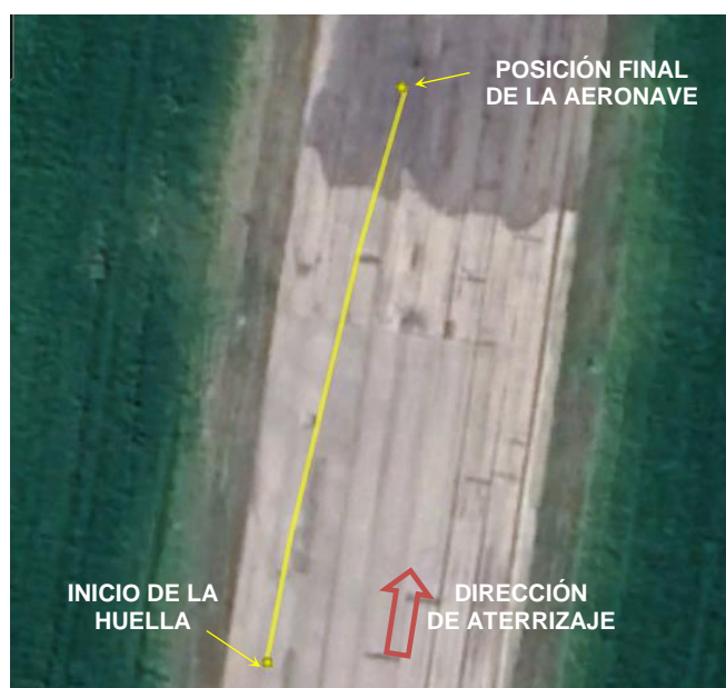
Imagen 5. Inicio de las huellas de la hélice contra el pavimento de la pista 02.
