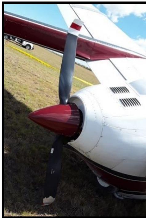
Imagen 7. Hélice trasera dañada.
