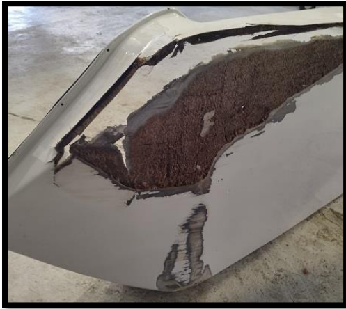
Imagen 5. Cargo Pad dañado
