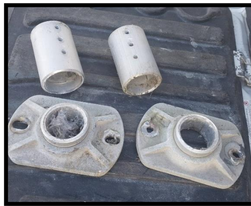
Imagen 6. Soportes del cartel afectado.
