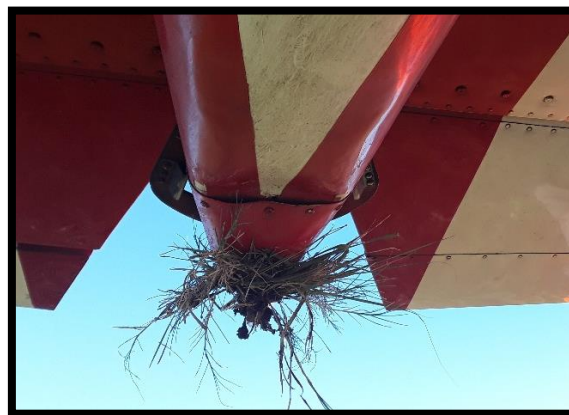
Imagen 3. Daños en el cono de cola.
